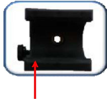
*flexFrame™ clips vengono utilizzati per collegare i tubi del telaio. E' importante notare che la "Thumb Screw" (vite) deve essere stretta dopo che la clip è stata agganciata al tubo del telaio. Dovete stringere solo le "Thumb Screws" sulle dip che si trovano sui Tubi Verticali (Montanti). Le clip utilizzate sui tubi verticali devono avere la "Thumb Screw" posizionata in basso come mostrato in figura.*
