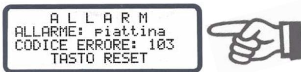
Attraverso il numero di errore è possibile risalire velocemente alla causa del guasto e localizzarlo in modo molto semplice. Un elenco dei possibili numeri di errore è riportato nel cap. 10.21 "Messaggi di errore" a pagina 46.
