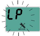
2) In caso di anomalia che provoca il fermo della caldaia il codice di errore viene visualizzato in modo lampeggiante direttamente sul display.
