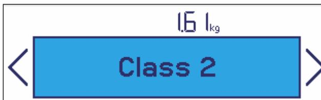
Le frecce sul lato sinistro e sul lato destro indicano che vi sono una classe al di sotto e una classe al di sopra della classe corrente.
