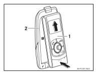
1. Inserire l'elemento di comando (1) nell'alloggiamento (2) fino a farlo scattare in sede come illustrato.
