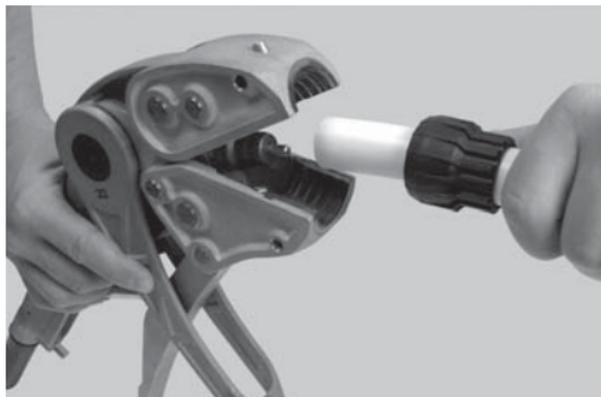
Après avoir glissé l'écrou de raccordement, introduire le tube JRG Sanipex MT jusqu'au seuil de résistance sur le mandrin dans la pince d'élargissement et fermer le levier de fixation (4).
