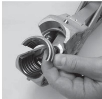
Premendo il perno superiore o inferiore, i rispettivi morsetti di chiusura (2) vengono rilasciati. Sfilare i morsetti dalla guida ed inserire i morsetti di chiusura desiderati fino a completare lo scatto.
