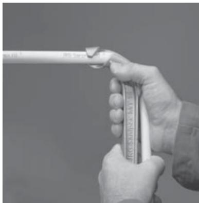
Piegatura del tubo. Durante la piegatura il tubo deve possibilmente seguire da vicino la curvatura della dima.
