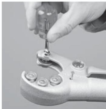
Allentare la vite a testa cilindrica con un cacciavite. Sostituire la rotella di taglio. Serrare la vite e togliere la spina di fermo.
