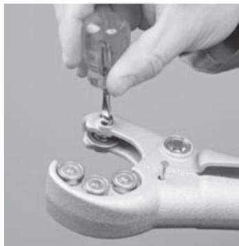
Desserrer la vis à tête cylindrique à l'aide d'un tournevis. Remplacer la molette. Serrer la vis et retirer la cheville d'arrêt.
