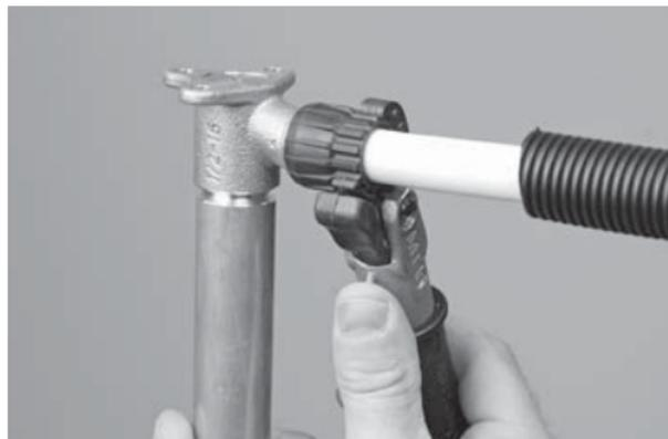
Serrer ensuite l'écrou de raccord à l'aide de la clé dynamométrique à cliquet (no. art. 4832). Pour maintenir, utiliser une douille d'ajustage (no. art. 5777) ou la contre-clé (no. art. 4834).
