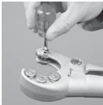
Mit einem Schraubenzieher die Zylinderschraube lösen. Das Schneidrad ersetzen. Schraube anziehen und Arretierstift entfernen.
