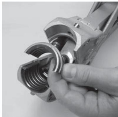
Durch drücken des oberen- oder unteren Lösestiftes wird die jeweilige Klemmbacke [2] freigegeben. Diese dann aus der Klemmbackenföhrung herausnehmen und die gewünschten Klemmbacken bis zum vollständigen Einrasten einsetzen.
