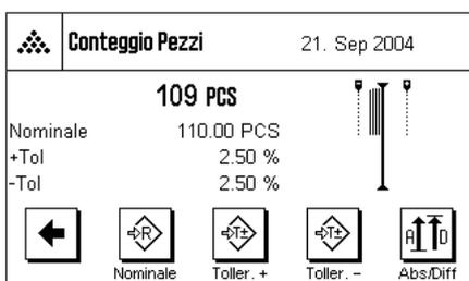
Una volta inseriti il valore nominale e le tolleranze, sul display appare la guida grafica per i dosaggi ("SmartTrac") con i limiti di tolleranza, utile per il dosaggio sulla base del valore nominale: È possibile dosare i campioni approssimativamente fino al raggiungimento della tolleranza minima, per poi, all'occorrenza, dosare accuratamente fino al valore nominale.
