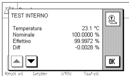
Il buon esito della verifica è confermato dalla finestra qui accanto. Se è collegata una stampante, la verifica viene stampata automaticamente in base alle indicazioni selezionate nelle impostazioni di sistema per il protocollo di verifica (sezione 3.6 nelle Istruzioni d'uso separate – Parte 3 per bilance XS). Al sezione 4.4.5 è disponibile un esempio.
