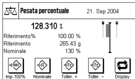
Non appena sono state inseriti il nominale e le tolleranze, verranno visualizzati i limiti di tolleranza per la guida grafica ("SmartTrac"). I limiti di tolleranza facilitano il dosaggio verso un valore nominale: In questo modo è possibile effettuare un dosaggio approssimativo del materiale finché non si raggiunge la tolleranza inferiore e poi, se necessario, effettuare un dosaggio accurato per raggiungere il nominale.
