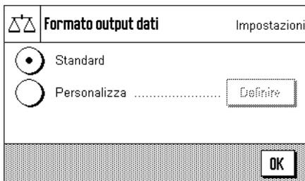
Nel menu "Formato output dati" è possibile stabilire come formattare sul computer host i risultati di pesata emessi. Ciò può essere necessario se la bilancia funziona contemporaneamente ad altri strumenti, programmi o periferiche che prevedono uno specifico formato di dati.
