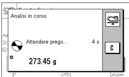
Posizionare il materiale da pesare sulla bilancia. Il peso deve essere superiore a quello indicato nel campo info "AutoStart", altrimenti il ciclo di pesate non potrà avviarsi automaticamente. Una volta avviato il ciclo, verrà visualizzata la finestra qui accanto.
