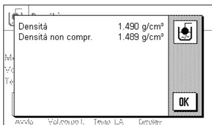
La bilancia determina la densità del liquido e visualizza il risultato (valore compensato o non compensato, a seconda delle impostazioni relative all'emissione del risultato, ved. sezione 7.3.5).
