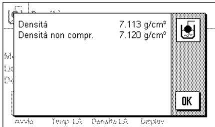
La bilancia determina la densità del corpo solido e visualizza il risultato (valore compensato o non compensato, a seconda delle impostazioni relative all'emissione del risultato, ved. sezione 7.3.5).
