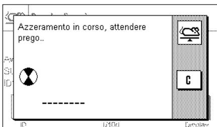
Non appena è stato rimosso il materiale pesato, il display si azzerà (se non è attivata la funzione "Tara automatica") e successivamente la bilancia è pronta per una nuova pesata.
