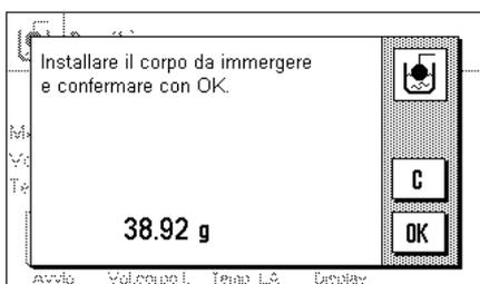
Premere il tasto funzione "Avvio", per dare inizio alla determinazione della densità. Verrà richiesta l'installazione del corpo a immersione (pesata in aria per la taratura).
