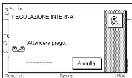
È possibile sentire la massa interna che viene meccanicamente messa in posizione e poi rimossa. Durante la regolazione, si illumina la finestra qui accanto. I simboli sono animati in modo tale da permettere all'utilizzatore di seguire il processo di regolazione anche visivamente. Premendo il tasto "Annulla" è possibile terminare il processo di regolazione in corso in qualsiasi momento.
