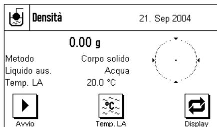
Selezionare, nelle impostazioni specifiche, il metodo "Corpi solidi" (sezione 7.3.2) e determinare il liquido ausiliario desiderato (sezione 7.3.3).
