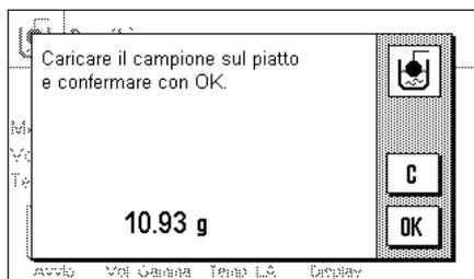
Premere il tasto funzione "Avvio" per dare inizio alla determinazione della densità. Verrà richiesto il posizionamento del campione (senza sfera gamma).
