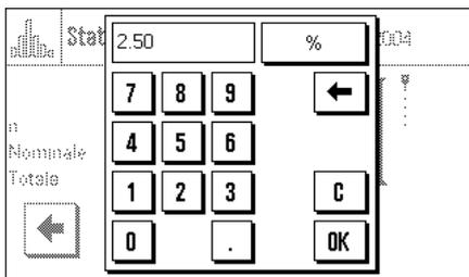
Con i tasti funzione "**Toller. +**" e "**Toller. -**" è possibile stabilire la precisione con cui si effettua il dosaggio. La finestra di inserimento è uguale a quella del peso nominale. All'origine, i valori di tolleranza sono impostati su 2.5 %.
