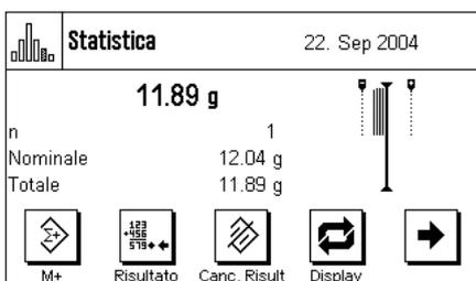
Una volta inseriti il valore nominale e le tolleranze, sul display appare la guida grafica per i dosaggi ("SmartTrac") con i limiti di tolleranza, utile per il dosaggio sulla base del valore nominale: È possibile dosare i campioni approssimativamente fino al raggiungimento della tolleranza inferiore, per poi, all'occorrenza, dosare precisamente fino al valore nominale.
