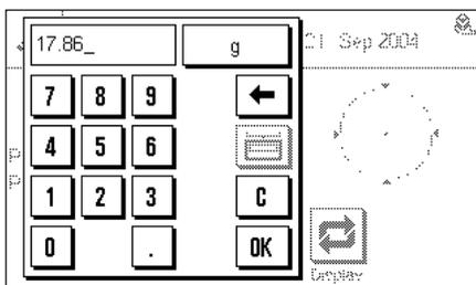
**Se il peso unitario è noto**, è possibile inserirlo direttamente. Premere il tasto funzione "PesPz". Appare un campo di inserimento, in cui è possibile inserire il peso unitario nell'unità desiderata.
