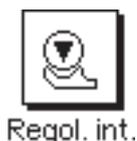
Premendo questo tasto funzione si attiva una regolazione della bilancia tramite massa di regolazione incorporata. Questa può avvenire in un momento stabilito; è possibile anche stabilire nell'impostazione di sistema che la bilancia richieda una regolazione non appena registra un cambiamento della temperatura stabilita (impostazione "CallInfo", sezione 3.4 nelle Istruzioni d'uso separate – Parte 3 per bilance XS).
