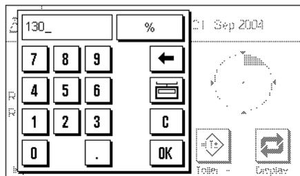
Premere il tasto funzione "**Nominale**". Digitare il valore desiderato (per es. 130 %). Controllare l'unità di misura, che viene visualizzata a destra del nominale. Premendo l'unità viene visualizzata una scelta delle unità disponibili, tra cui anche il "%" (l'unità "per cento" è disponibile solo dopo che è stato rilevato il riferimento).
