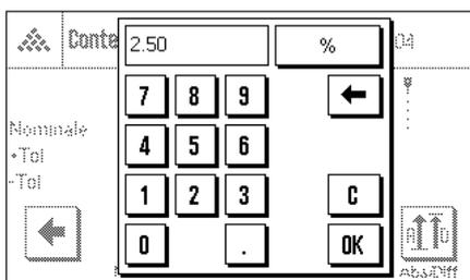
Con i tasti funzione "Toller. +" e "Toller. -" è possibile stabilire l'accuratezza con cui si effettua il conteggio. La finestra di inserimento è uguale a quella del peso nominale. All'origine, i valori di tolleranza sono impostati su 2.5%. Dopo l'inserimento del valore percentuale, premere "OK", per attivare la tolleranza. I conteggi che non rispettano le tolleranze vengono contrassegnati in modo particolare durante la stampa dei valori singoli (con ">T" o "<T").
