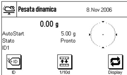
Per effettuare una pesata dinamica con avvio automatico è necessario attivare la funzione "AutoStart" e stabilire il peso minimo corrispondente (sezione 10.3.4). Non è necessario attivare alcun tasto funzione specifico, tuttavia si raccomanda di attivare il tasto funzione "ID", nel caso in cui si desideri assegnare a ogni campione un'identificazione. I campi info "AutoStart" e "Stato" sono già attivati all'origine (sezione 10.3.7).
