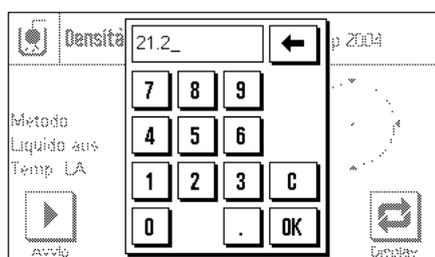
Se si utilizzano **acqua o etanolo come liquidi ausiliari**, inserire la **temperatura** tramite il tasto funzione "Temp. LA" (per entrambi i liquidi sono memorizzate, nella bilancia, le tabelle della densità in considerazione di un campo di temperature da 10 °C a 30 °C, ved. anche i sezioni 7.7 e 7.8). La figura a fianco mostra il campo di inserimento corrispondente (inserimento in °C con 1 decimale).
