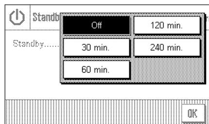
Si può disattivare la funzione di risparmio energetico (“Off”) o impostare un tempo di 30, 60, 120 o 240 minuti, trascorso il quale la bilancia passa in modalità “Standby”. La modalità “Standby” coincide con lo stato in cui si trova la bilancia dopo lo spegnimento tramite il pulsante «On/Off». Per riaccendere la bilancia, premere il tasto «On/Off».
