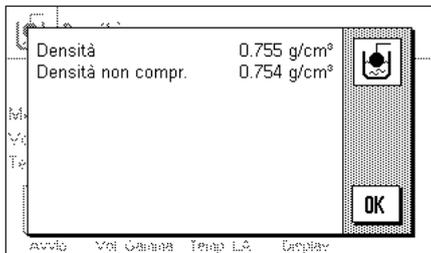
La bilancia determina la densità della sostanza pastosa e visualizza il risultato (valore compensato o non compensato, a seconda delle impostazioni relative all'emissione del risultato, ved. sezione 7.3.5).
