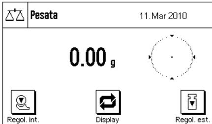
Il risultato della bilancia, è configurato in modo tale che il risultato di pesatura e di grafica di riempimento (guida "SmartTrac"), sarà visualizzato sul display di medie dimensioni. Le informazioni dei campi non sono visibili con quest'impostazione.
