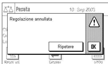
**Durante la regolazione si è verificato un errore e il processo è stato bloccato.** Questo messaggio compare anche se si decide di interrompere la regolazione. È possibile ripetere il processo di regolazione o tornare all'applicazione premendo "OK".
