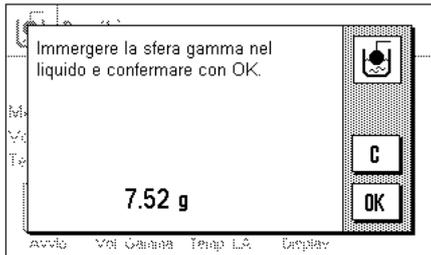
Dopo la taratura del campione verrà richiesto di immergere la sfera gamma nella sostanza campione.
