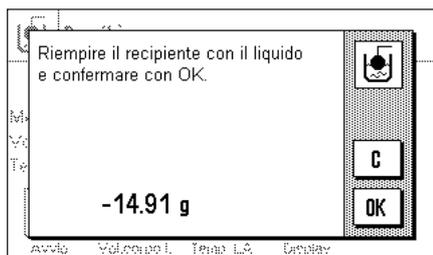
Dopo la tara del corpo a immersione, viene richiesto di versare il liquido, di cui occorre determinare la densità, in un recipiente.
