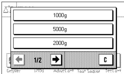
Dopo aver premuto il tasto funzione "Regol. est." appare un elenco delle varie masse di regolazione selezionabili (sezione 3.1.11 nelle Istruzioni d'uso separate – Parte 3 per bilance XS) appariranno su questo schermo. selezionare un dei pesi esterni di prova.
