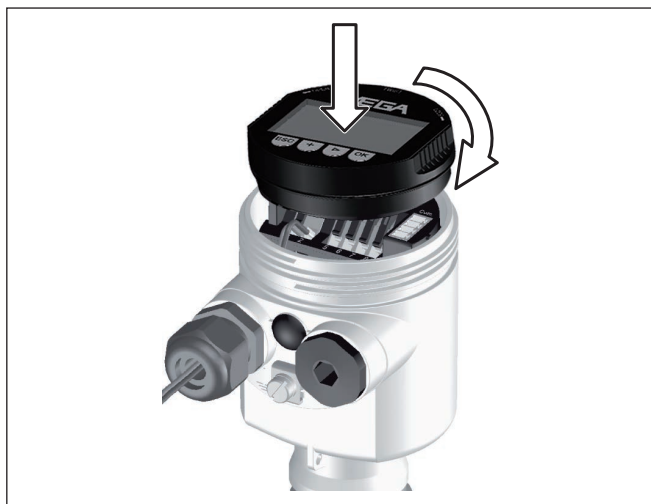
Figura 15: Installare il tastierino di taratura con display
