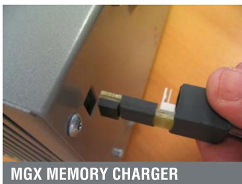
Connessione a caricabatterie a bordo con adattatore
