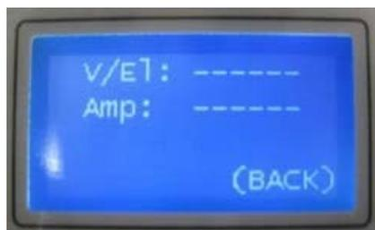
Collegando l' MP-Top II al caricabatterie in carica il display passa alla visualizzazione di Tensione e Corrente di carica:
