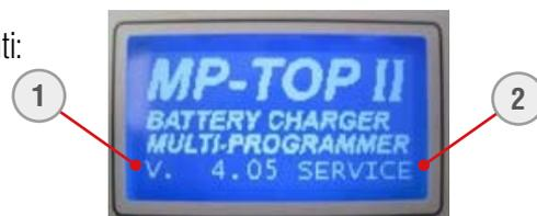
*ATTENZIONE: Se il dispositivo non dovesse accendersi in modo regolare o dovesse avere un funzionamento anomalo, è possibile eseguire il reset del dispositivo tenendo premuto il pulsante ENTER per 10 secondi.*
