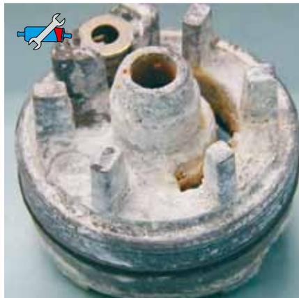
Fig. 50: Cuscinetto esterno coperto di calcare di una pompa di alimentazione carburante
