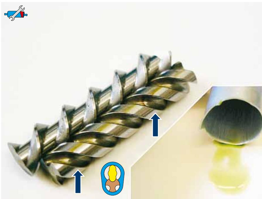
*Fig. 55: Incollature dovute ad un fluido convogliato non consentito. La figura mostra il meccanismo di pompaggio di una pompa ad elica del tipo E3L. Dal corpo tagliato per l'esecuzione della perizia fuoriescono ancora residui di un fluido verde. Questo «carburante» ha incollato il meccanismo di pompaggio. Il punto in cui le due viti di alimentazione della pompa erano incollate è perfettamente riconoscibile per la presenza di depositi sulla vite di alimentazione (freccia).*
