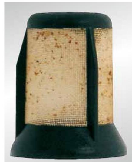
Fig. 23: Filtro a reticella sporco di una pompa ad anello dentato E3T
