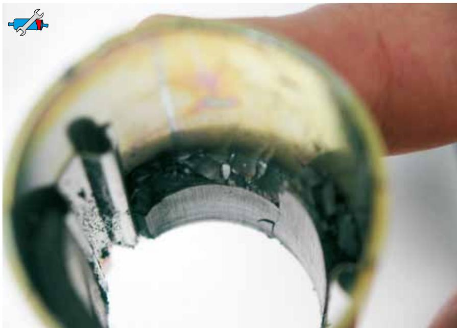
*Fig. 80: Magnete permanente (statore) spezzato*
