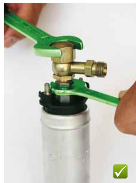
*Fig. 71: Montaggio corretto: sull'esagono inferiore della pompa di alimentazione è necessario effettuare il bloccaggio*
