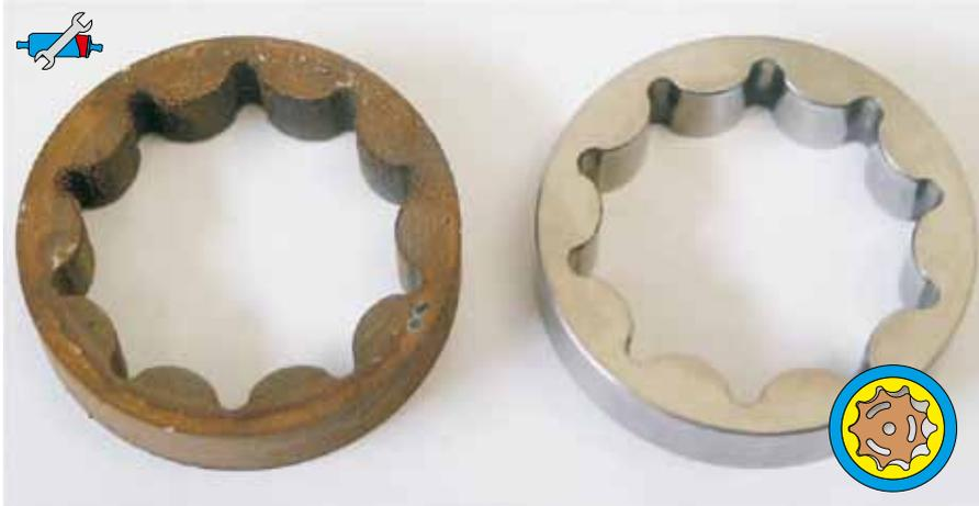
Fig. 48: A sinistra: anello dentato trocoidale fortemente arrugginito; a destra: stato a nuovo
