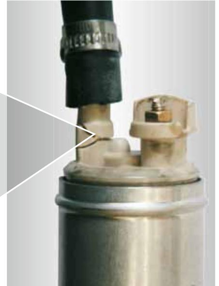
Fig. 74: Raccordo per tubo flessibile spezzato
