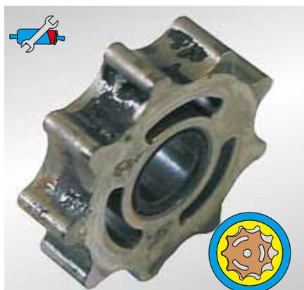
**Fig. 32: Sigillante nel meccanismo di pompaggio (ruota dentata trocoidale)**
