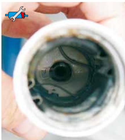
*Fig. 44: Acqua in una pompa di alimentazione carburante*
