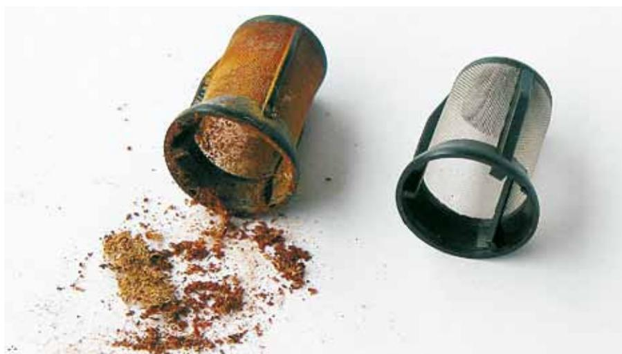
*Fig. 41: A sinistra: filtro a reticella otturato dalla ruggine; a destra: filtro a reticella nuovo*
