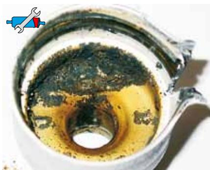
Fig. 18: Vista all'interno del corpo aperto di una pompa ad anello dentato E3T otturata da depositi di sporco
