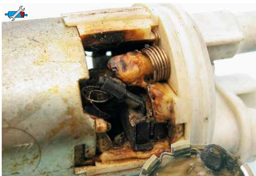
Fig. 20: Danni da fusione in seguito a funzionamento a secco
