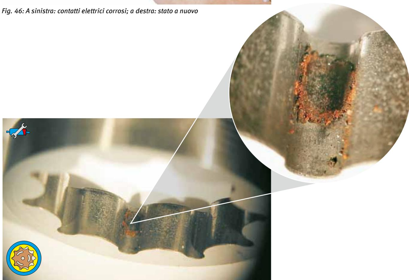
*Fig. 47: Anello dentato trocoidale bloccato da particelle di ruggine (immagine sotto il microscopio)*
