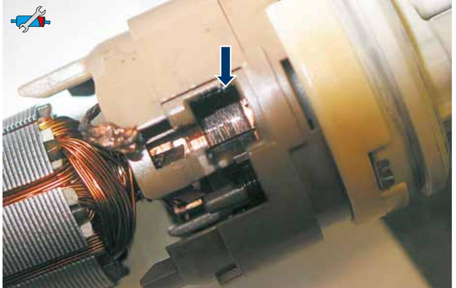
*Fig. 61: Vista sul supporto dei contatti striscianti
