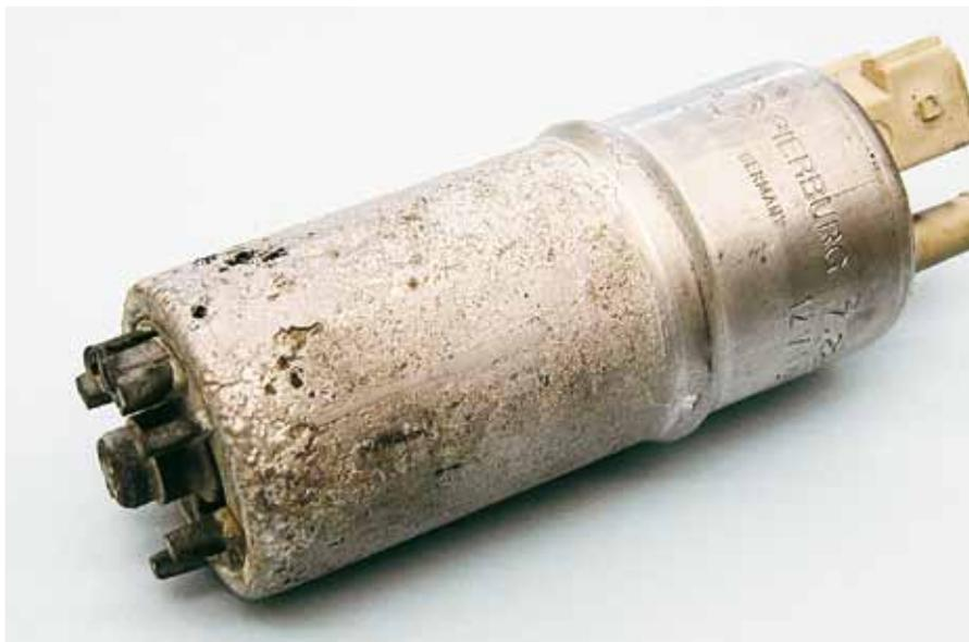
Fig. 72: Corrosione da contatto dovuta all'abbinamento di materiali non compatibili
