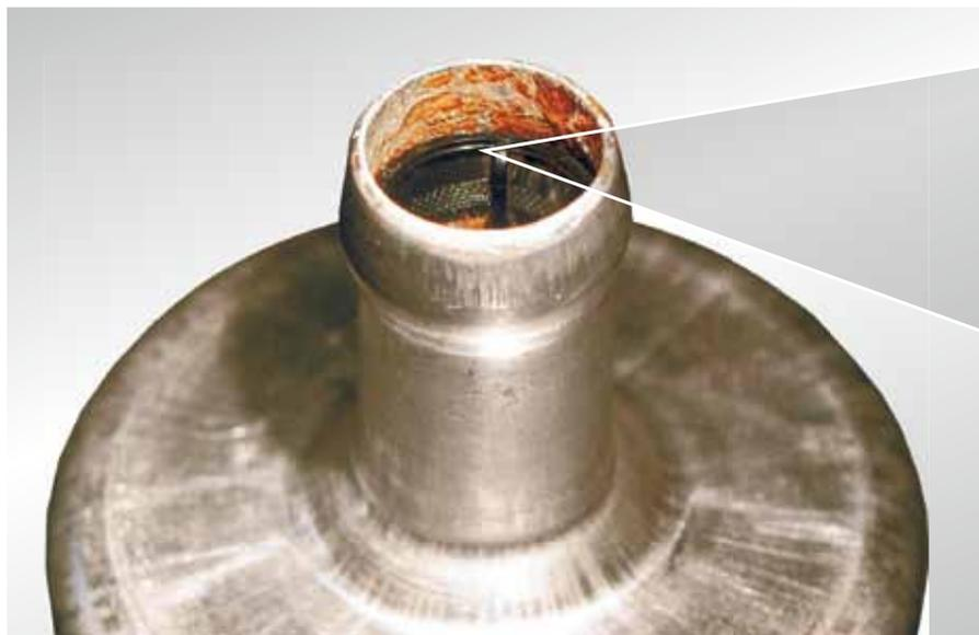
*Fig. 40: Raccordo di entrata arrugginito di una pompa a palette E1F*
