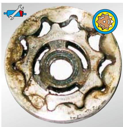
Fig. 19: Meccanismo di pompaggio bloccato (anello dentato trocoidale) di una pompa ad anello dentato E3T
