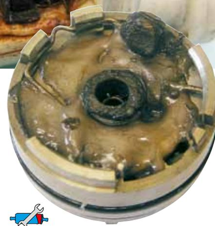
Fig. 21: A causa del funzionamento a secco si sono fusi i componenti di plastica nella pompa di alimentazione carburante
