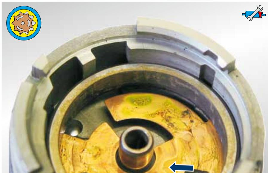
*Fig. 59: Meccanismo di pompaggio con incollature
