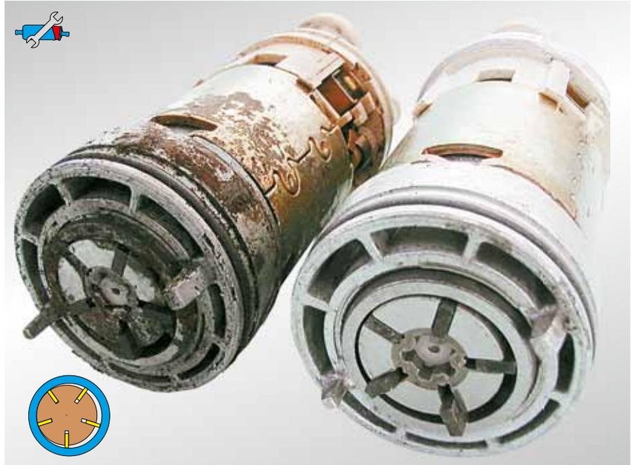
Fig. 36: Danno da acqua su una pompa a palette
