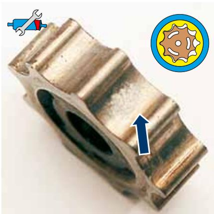
Fig. 49: Anello dentato trocoidale con depositi di calcare
