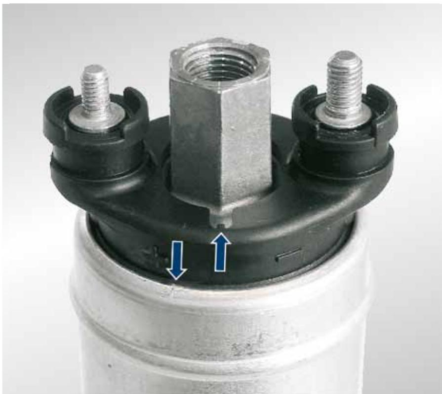
*Fig. 69: Coperchio pompa spostato
