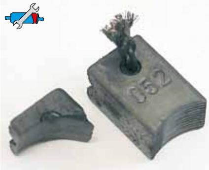
*Fig. 62: Contatti striscianti dopo una percorrenza di ca. 15.000 km
