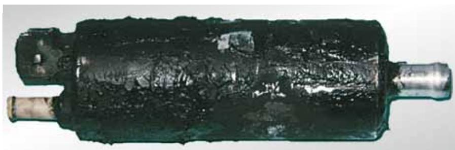
*Fig. 65: Pompa in-line utilizzata come pompa in-tank*
