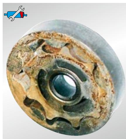
Fig. 53: A confronto: un meccanismo di pompaggio trocoidale arrugginito. Qui è impossibile qualsiasi movimento.
