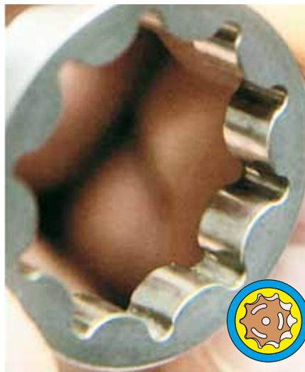
Fig. 51: Anello dentata trocoidale (a sinistra con depositi di calcare e a destra nello stato a nuovo)
