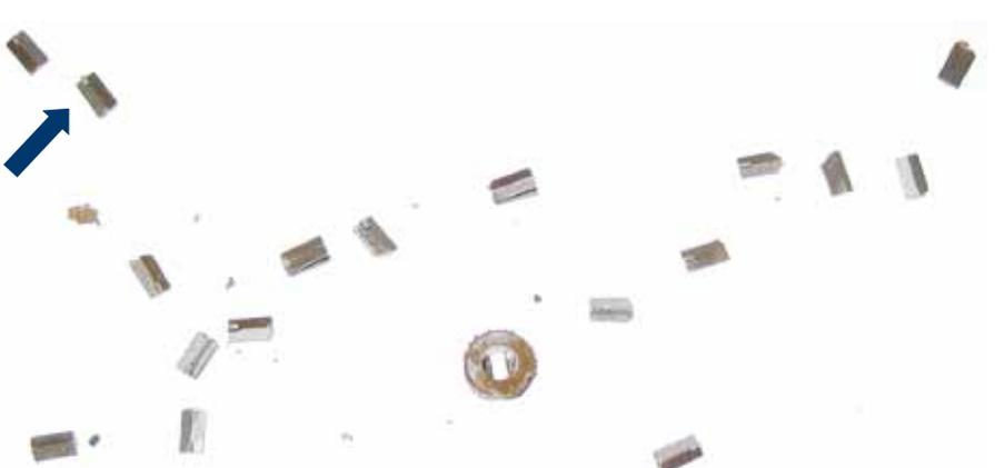
*Fig. 34: Le nervature della girante di una pompa a canale laterale del tipo E15 sono state distrutte da un corpo estraneo (a sinistra). I relativi frammenti (a destra) sono andati a finire nel filtro.*
