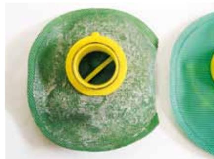
*Fig. 42: A sinistra: depositi di calcare sul filtro di una pompa in-tank; a destra: a confronto un filtro nuovo*
