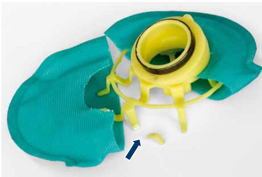
Fig. 76: Nervature di rinforzo spezzate nel filtro di una pompa in-tank
