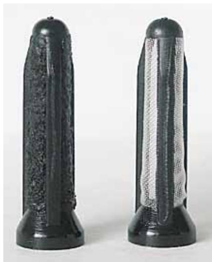
Fig. 22: Filtro a reticella di una pompa a palette E1; F a sinistra otturato – a destra nuovo
