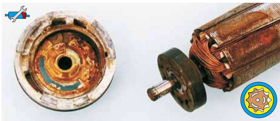
Fig. 37: Pompa ad anello dentato E3T – con depositi di ruggine e calcare
