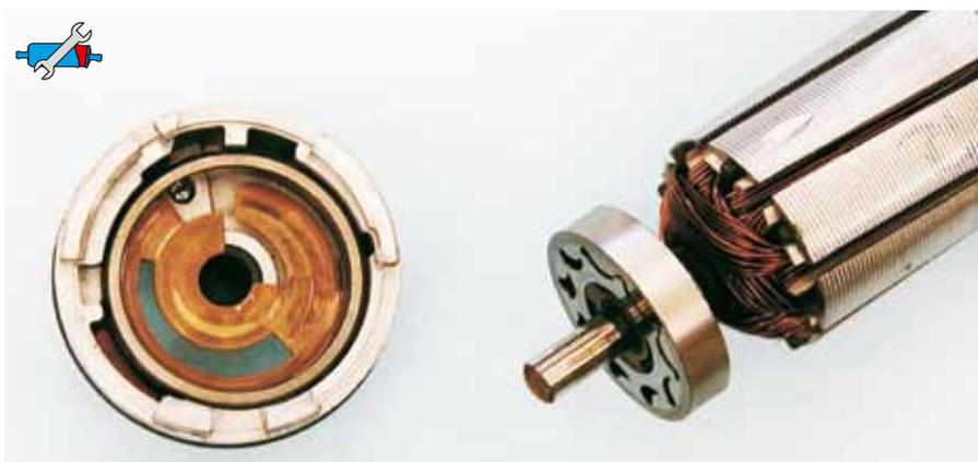
Fig. 38: A confronto: pompa ad anello dentato E3T – in buono stato nonostante un chilometraggio elevato
