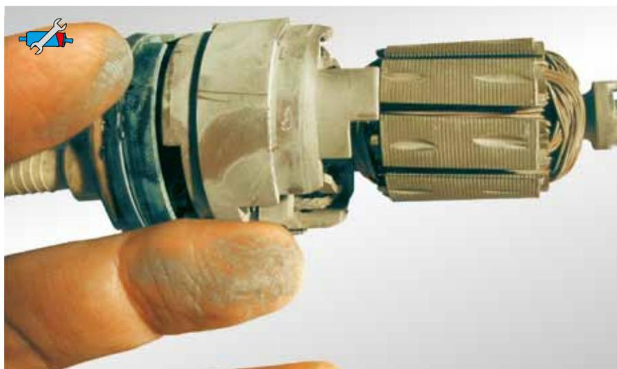
*Fig. 56: Deposito dovuto a carburante di scarsa qualità*
