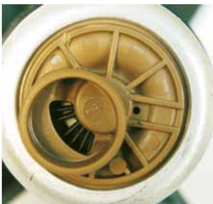
*Fig. 35: A confronto: vista nel raccordo di aspirazione di una pompa a canale laterale con girante integra*
