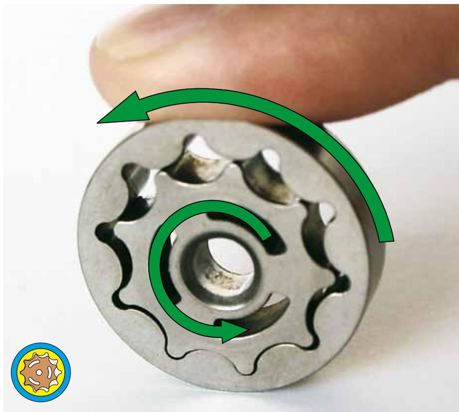
Fig. 52: Un meccanismo di pompaggio trocoidale deve scorrere senza alcuna difficoltà
