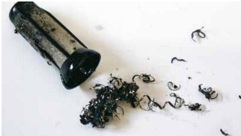
**Fig. 29: Trucioli nel filtro a reticella**
