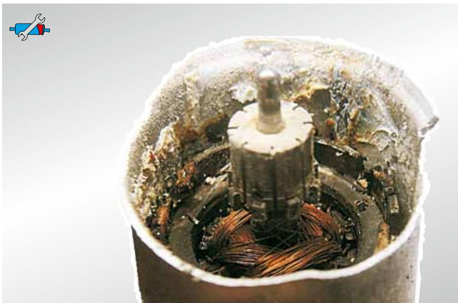
*Fig. 16: Pompa elettrica di alimentazione carburante fortemente corrosa. Un'immagine che il meccanico in officina normalmente non vede mai. In molti casi si riesce ad individuare la causa per l'avaria di una pompa solo aprendola, in quanto essa sembra perfettamente integra dall'esterno.*
