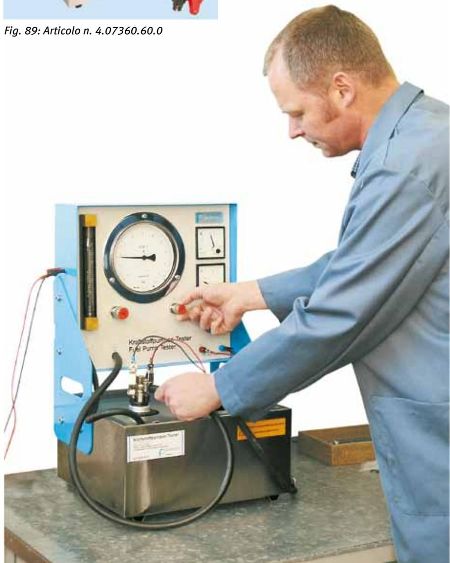
Fig. 90: Modalità d'uso tester per pompe di alimentazione carburante 4.07370.60.0
