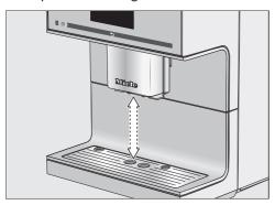
È possibile disattivare la regolazione dell'erogatore. Durante la preparazione delle bevande, l'erogatore centrale rimane nella posizione superiore. Se si effettuano programmi di manutenzione, l'erogatore centrale si posiziona all'altezza dei contenitori o in una posizione manutenzione.
