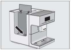
Il filtro del serbatoio dell'acqua è intasato.
