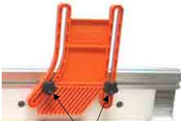
...mettere il pressore e fissarlo con i due pomelli
