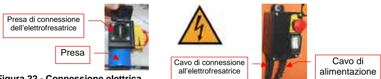
**Figura 22 - Connessione elettrica**
