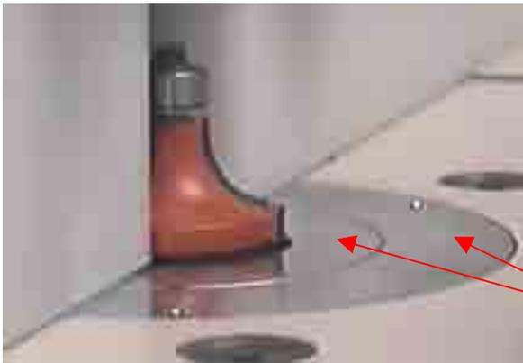
Applicare sul piano di lavoro gli anelli interdipendenti, in base al tipo di utensile utilizzato e alla sua regolazione.
