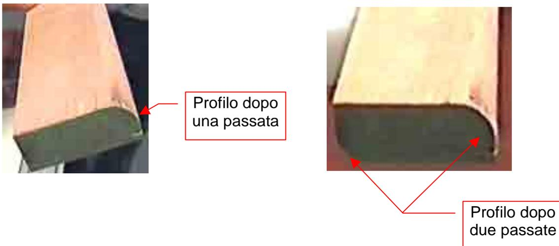
**Figura 2 - Profili realizzati**
