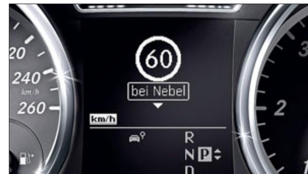
Lo Speed Limit Assist compare sia sul quadro strumenti che sul display centrale del COMAND Online.
