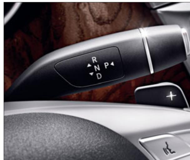
Il cambio può essere azionato con la leva del cambio al volante DIRECT SELECT. Il guidatore può cambiare marcia azionando i comandi al volante.
