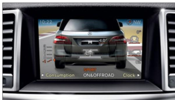
Programma di marcia, pendenza e angolo di inclinazione vengono visualizzati sul display del COMAND.
