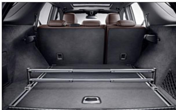
Il kit di fissaggio EASY-PACK agevola le operazioni di carico.
