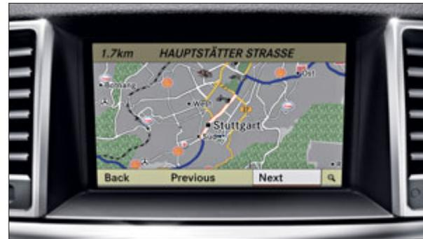
Il sistema multimediale con sistema di navigazione su hard disk è dotato di un display a colori ad alta risoluzione con una diagonale da 17,8 cm.
