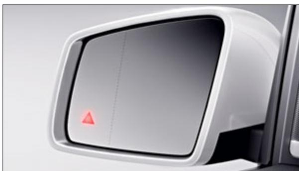
Il Blind Spot Assist attivo allerta il guidatore se una vettura si trova in corrispondenza dell'angolo morto durante un cambio corsia.
