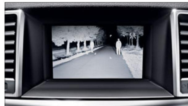
Il sistema di visione notturna Nightview Plus è dotato di uno speciale segnale di riconoscimento dei pedoni sul display, per renderli ancora più visibili.
