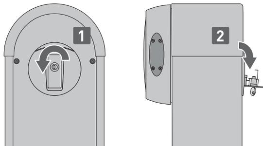
In caso di guasto o di mancanza di tensione, inserire e ruotare la chiave in senso antiorario, aprire completamente lo sportello. Aprire manualmente la barriera.
