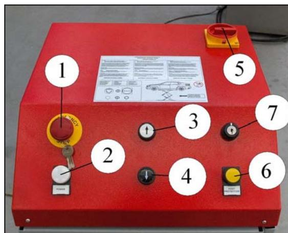
Premere il pulsante di salita "UP" (3) nel pannello di controllo e sollevare il carico fino a quando le ruote del veicolo non perdono contatto col terreno. Prima di continuare il sollevamento, assicurarsi che il veicolo sia posizionato correttamente sui tamponi di gomma.
