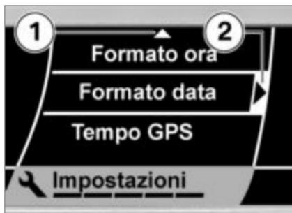
Una freccia **1** sul bordo superiore o inferiore del display indica che ruotando il Multi-Controller nella direzione corrispondente si possono raggiungere altre opzioni. Se nel cursore viene indicata la freccia **2**, premendo il Multi-Controller verso destra viene richiamato un sotto menu (per il significato diverso nel caso dei valori medi e della scelta nell'elenco vedere (►► 45)).
