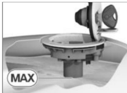
**!** Sotto l'effetto del calore il carburante si espande. Con il serbatoio rifornito eccessivamente il carburante può fuoriuscire e venire a contatto con il fondo stradale, con conseguenti rischi di cadute.
