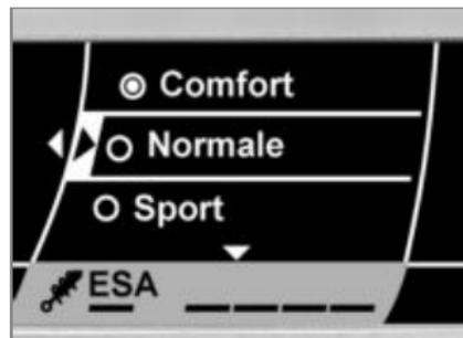
Le possibilità di regolazione per l'ammortizzazione vengono visualizzate.
