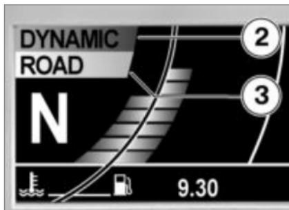
Sulla posizione **2** viene rappresentata la regolazione attuale, ogni volta in cui si preme un tasto sulla posizione **3** compare una delle modalità di marcia possibili.
