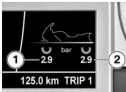
La pressione di gonfiaggio indicata si riferisce ad una temperatura degli pneumatici di 20 °C. Il valore di sinistra **1** indica la pressione di gonfiaggio della ruota anteriore, il valore di destra **2** la pressione di gonfiaggio della ruota posteriore. Subito dopo l'inserimento dell'accensione viene visualizzato "-- --", poiché il trasferimento dei valori della pressione pneumatici inizia solo dopo il primo superamento dei 30 km/h.<
