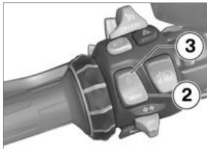
Con il tasto **2** vengono richiamati i menu possibili, iniziando con il menu **Info**. Ogni ulteriore azionamento del tasto **2** richiama un menu successivo, il numero dei menu dipende dall'equipaggiamento della vettura. Mediante il tasto **3** è possibile accedere direttamente a un menu selezionabile.
