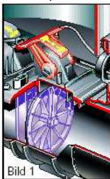
Fig. 1 La chiusura di emergenza può essere bloccata manualmente
