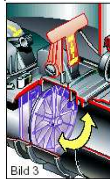
Fig. 3 Valvola antiriflusso liberamente sospesa
