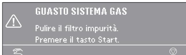
Pulire il filtro come descritto al capitolo "Cura e pulizia" e premere infine il tasto "START". Nelle macchine con riscaldamento a gas un'eccessiva formazione di schiuma può determinare un guasto.
