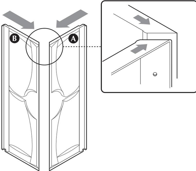
I pannelli sono reversibili, quindi si possono montare con la rubinetteria a destra o a sinistra. Una volta deciso il lato di montaggio accoppiare le due pareti in angolo (fig.3) e serrare con le viti in dotazione per ottenere il completo bloccaggio in questa posizione (fig.4). Applicare la guarnizione (vedi fig. A).
