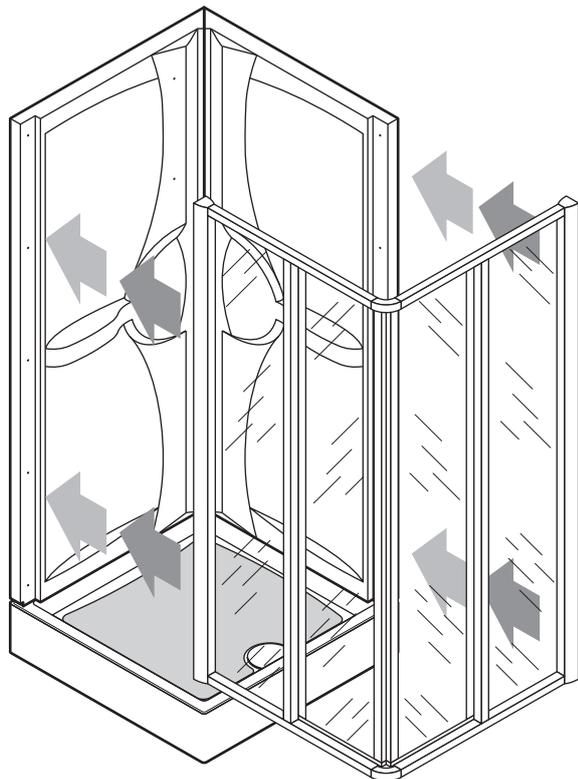
Posizionare il box preassemblato sulla cabina (fig.9) e centrarlo sui due lati in modo da avere la stessa distanza tra il bordo del pannello il bordo del piatto e i profili del box.
