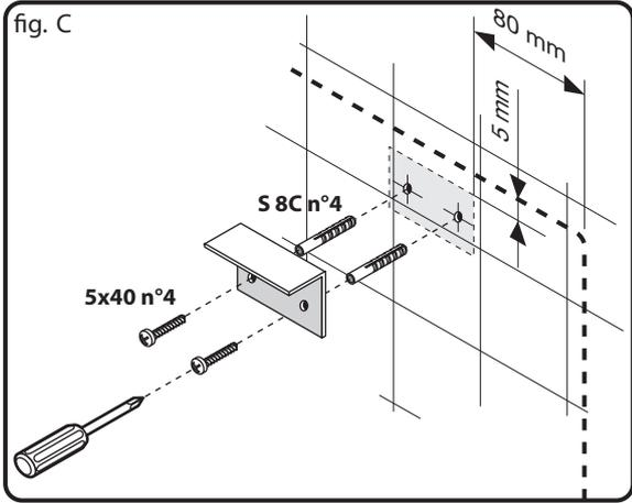
Posizionare le staffe di fissaggio delle pareti al muro ad un'altezza pari a quella della cabina meno 5mm e segnare i fori con una matita (fig. A). Forare con una punta da muro ø8 mm (non in dotazione), attenzione a non utilizzare la funzione percussione sulle piastrelle (fig. B), inserire i tasselli e fissare le staffe in posizione con le viti da 5x40mm (fig. C).
