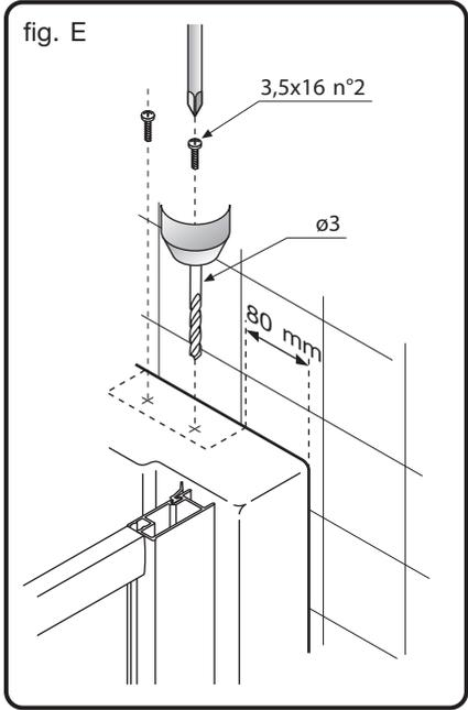
Segnare e forare i pannelli in corrispondenza delle staffe a muro, avvitare e bloccare (fig. D e fig. E).
