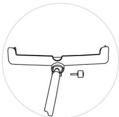
(2). Inserisci la testa a palla dell'asta di supporto nella superficie sferica concava del supporto del controllo box manuale.
