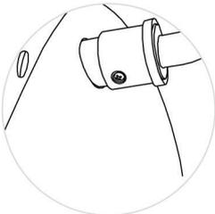
(10). Avvita le due viti su ogni lato per finire l'installazione.
