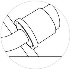
(8). Inserisci i componenti della staffa del box di controllo manuale nel tubo fisso cilindrico, ricordando che all'interno e all'esterno del set di ogni buco montante dovrebbe corrispondere un altro.
