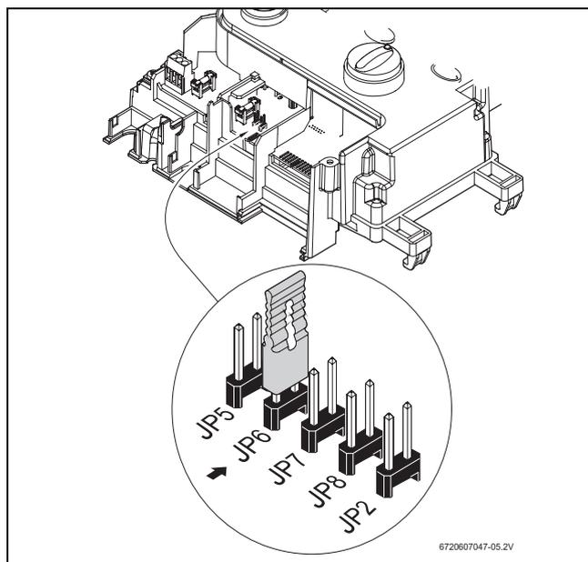
Fig. 22 Posizione morsetti e ponticello
