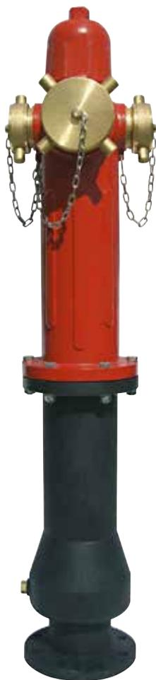
Idranti soprasuolo DN 80 e DN 100 a norma UNI EN 14384 in ghisa, tipo a secco, con scarico automatico antigelo. Gli sbocchi UNI 70 ed UNI 100 sono realizzati con attacco maschio filettato a norma UNI 810 in ottone EN 1982. Tappi in ottone unificati. Gli idranti di tipo C, con dispositivo di rottura, sono provvisti di uno speciale sistema che mantiene chiusa la valvola anche in caso di urto accidentale. Tutti gli idranti sono provvisti di volantino di apertura rotante pentagonale unificato.
