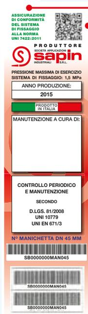
Conformità del sistema di fissaggio alla norma **UNI 7422-2011** - massima pressione di esercizio 1,5 MPa (15 bar)
