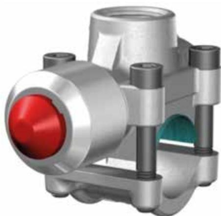
Il raccordo a T per derivazioni di tubature più rapido e facile da montare. Significativo risparmio di tempo e spesa di montaggio. Semplicità di montaggio anche nei punti di collegamento più difficili.- Omologazione SVGW. Per tubi in acciaio a norma DIN 2440 / 2444, acciaio 37,0. Tagliente in acciaio, tenuta DIN 3754<>. Massima temperatura d'esercizio: 120°. Massima sovrappressione d'esercizio: 25 bar.
