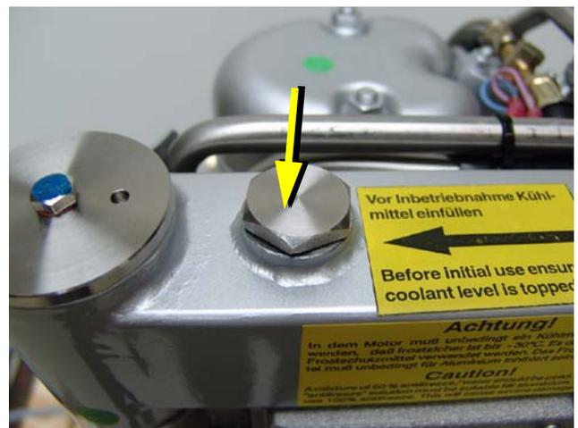
Fig. A.9: Bocchettone di riempimento dell’acqua di raffreddamento
