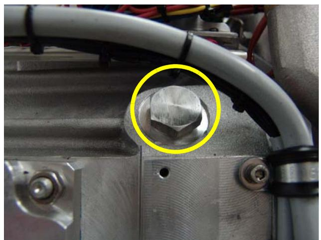
Fig. A.33: Tappo del sensore di velocità
