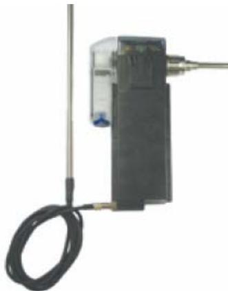
Collegamento della sonda di temperatura aria comburente con cavo alla base dell'analizzatore sonda
