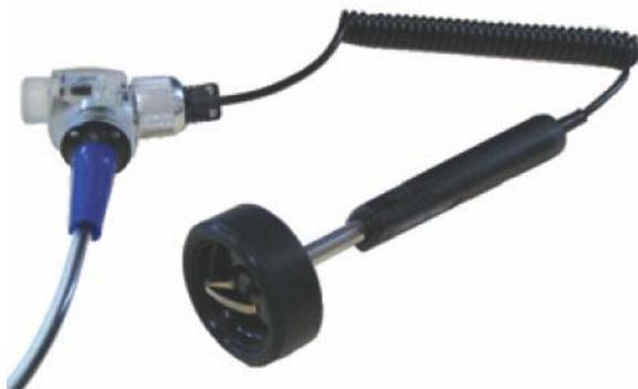
Sensore tipo W-02 su sonda fumi dell'A600
