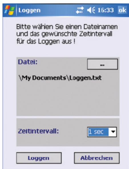
Esistono diversi modi per selezionare gli intervalli di misura durante l'analisi e di memorizzarli in TXT oppure excel. Se l'analisi viene "Registrata" verrà aperta una finestra che permette di memorizzare la registrazione dell'analisi, selezionando il nome del file, la posizione della memorizzazione, il formato (TXT o excel) e l'intervallo.
