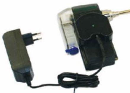
Caricamento batterie con adattatore e alimentatore da rete
