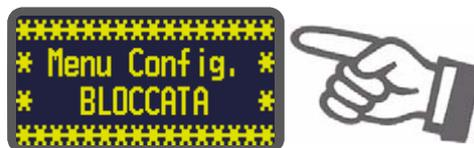
Questa visualizzazione compare anche quando si richiama per 5,0 sec. il menu di configurazione per segnalare il bloccaggio.
