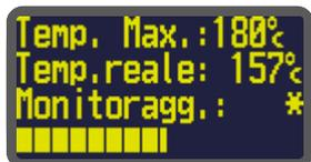
In questo modo è possibile controllare in qualsiasi momento il ciclo di riscaldamento e di regolazione. Il modulo di sorveglianza RESISTRON RESM-5 fornisce inoltre ai morsetti 17+14 un segnale analogico
