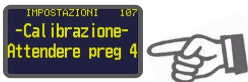
In caso di oscillazioni termiche del termocoduttore, la funzione "AUTOCAL" viene eseguita al massimo 3 volte. Se a questo punto non è possibile terminare con successo la funzione, viene emesso un messaggio d'errore (☞ cap. 9.18 "Messaggi d'errore" a pagina 39).
