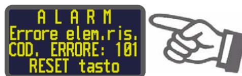
Tramite il codice d'errore visualizzato, è possibile individuare velocemente e semplicemente la causa del guasto. Nel cap. 9.18 "Messaggi d'errore" a pagina 39 sono elencati i possibili codici d'errore.
