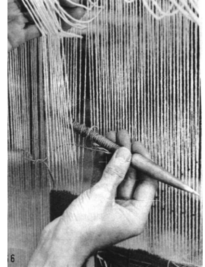
Lo spolino è passato completamente lasciando dietro di sé il filo di trama
