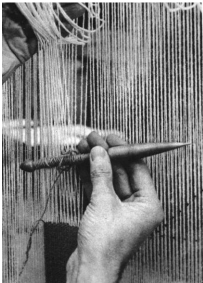
Posizione di partenza dello spolino per la prima mezza trama
