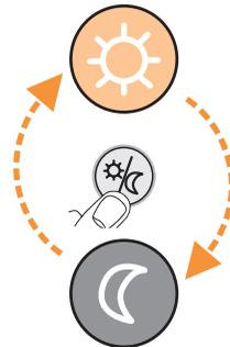
Sul display viene indicata la modalità operativa di funzionamento **D** (*diurna*) o **N** (*notturna*) preceduta dall'indicazione del modo di attivazione **a** (*automatico*) o **m** (*manuale*).
