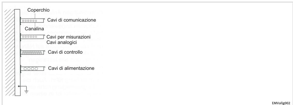
Fig.6-7 Cavi posati in canaline separate
