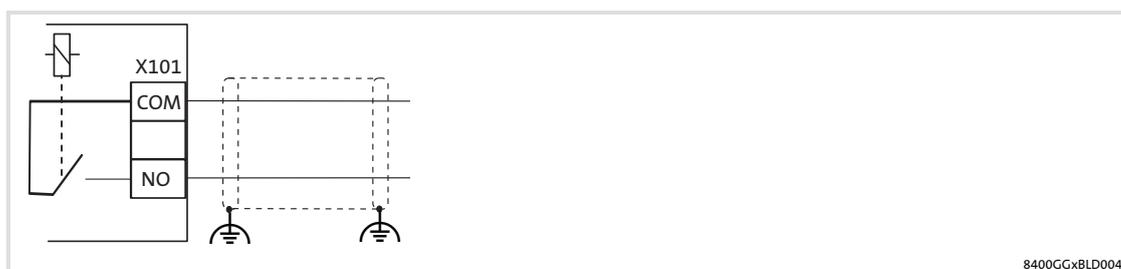
Fig.6-22 Cablaggio dell'uscita relè
