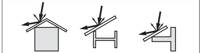
Figura 15: Copertura di profili piatti mediante deflettori
