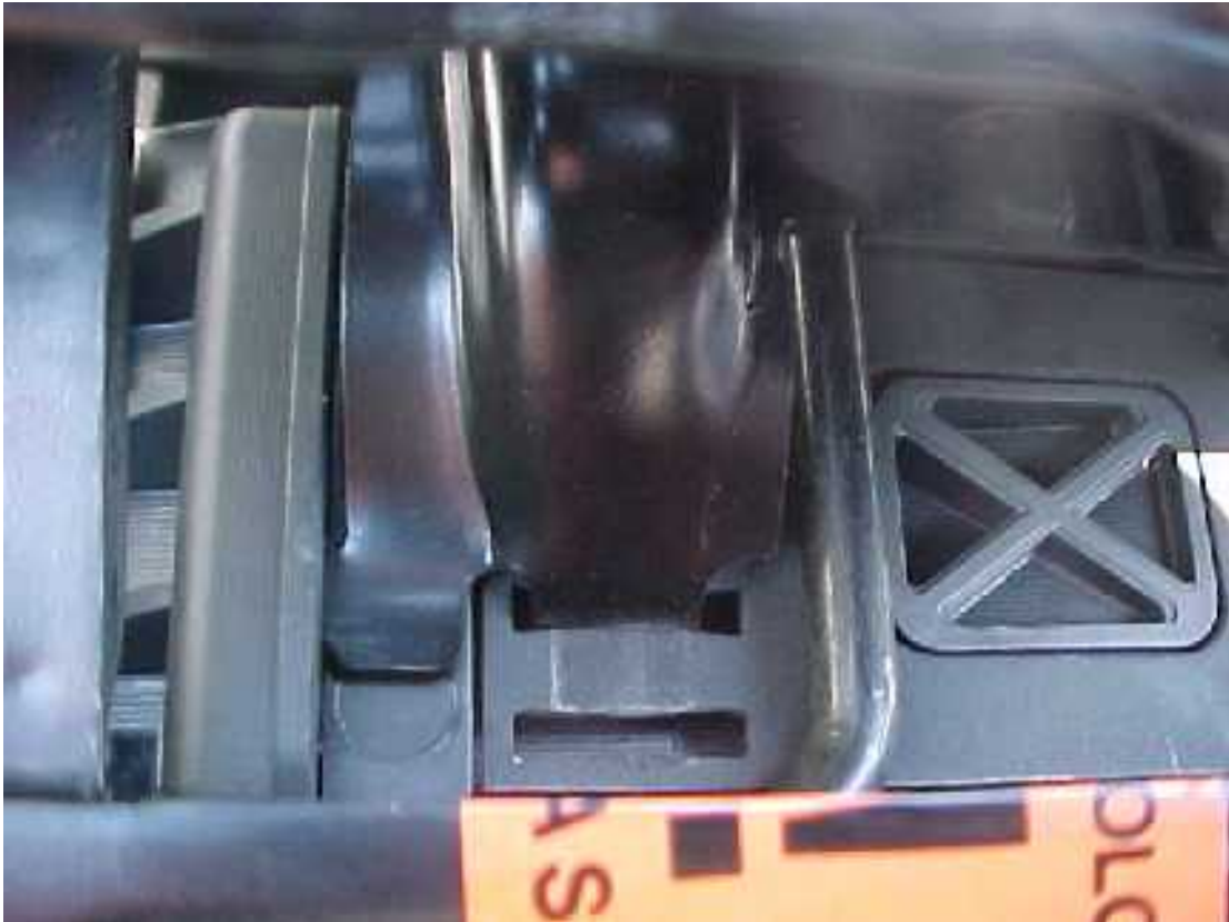
Far scattare le regolazione del bracciolo del sedile (lato sinistro)
