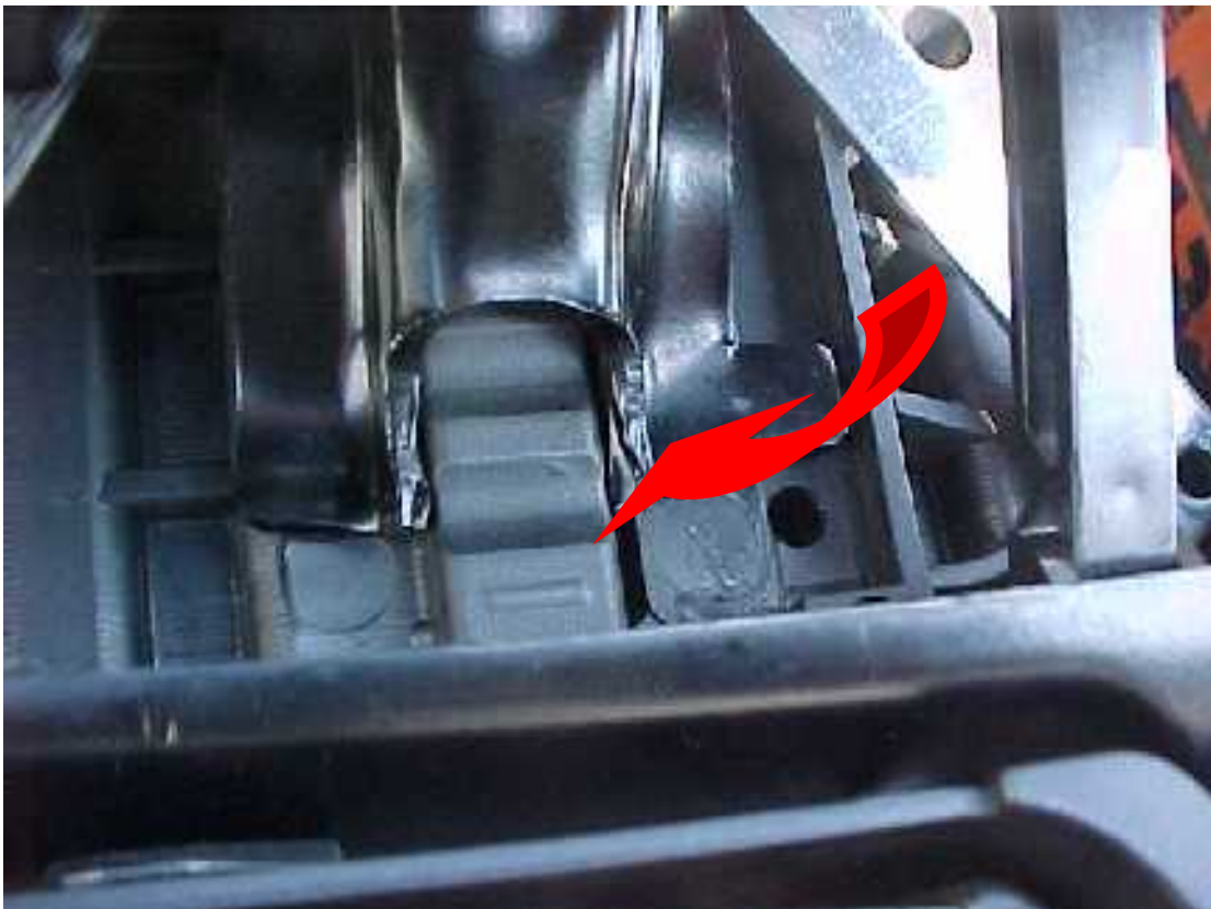
Posizionare la regolazione del bracciolo (lato destro) e ruotare verso l'interno il lardone di sicurezza
