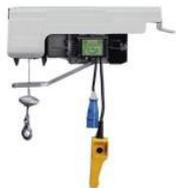
Trattasi di attrezzatura utilizzata per il sollevamento di carichi. L'argano elettrico può essere montato in posizione scorrevole su una rotaia sostenuta da cavalletti oppure sistemato in modo da ruotare orizzontalmente appeso ad un'apposita struttura portante (bandiera).
