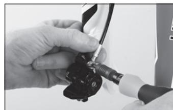
◀ Orientate il tubo in modo che scorra lungo il telaio o la forcella. Fissate il tubo direttamente all'allacciamento e stringete la vite di chiusura con la chiave di serraggio dinamometrica MAGURA. Coppia di serraggio: 3 Nm.
