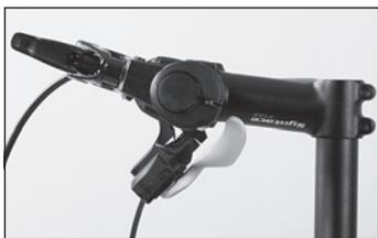
◀ Ruotate il corpo leva in posizione orizzontale e quindi di 1 cm verso l'alto. Stringete nuovamente il dado di serraggio del corpo leva.
