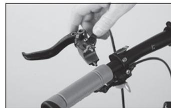
◀ Posizionare il corpo leva sul manubrio, applicate nuovamente la fascetta di serraggio e ruotate entrambi i dadi facendo fare 2 giri sulle viti passanti. Quindi stringete a fondo il dado di serraggio superiore. Coppia di serraggio: 3 Nm.
