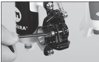
◀ Svitare la vite di fissaggio delle pastiglie con la chiave Torx T25.
