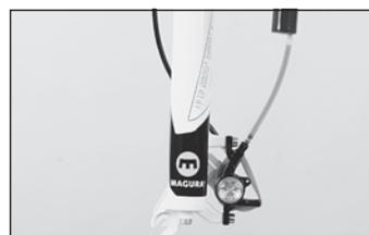
◀ Fate fluire lentamente l'olio minerale attraverso il freno utilizzando la siringa inserita nella pinza fino a che il flacone del kit Pro Bleed nel corpo leva è pieno.
