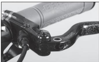
◀ Estraiete il LEVER Cube e l'espulsore. Il perno della leva freno dovrebbe sporgere dal corpo leva di circa 1,5 mm.
