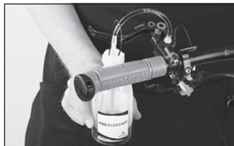
◀ Quando, eseguendo i passaggi sopra descritti, vedete che non escono più bolle d'aria, aspirate l'olio minerale con la siringa in basso fino a che in quella in alto resterà poco olio minerale.
