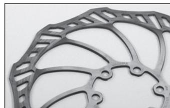
Anche i dischi del freno si usurano a causa dello sfregamento con le pastiglie. I freni a disco MAGURA sono dotati di un sistema automatico di compensazione dell'usura che fa sì che il punto di pressione del freno sia sempre nella stessa posizione. Per questo è necessario verificare lo stato di usura dei dischi ad ogni cambio delle pastiglie. Se i dischi sono usurati devono essere sostituiti con ricambi originali. Ogni volta che sostituite un disco sostituite anche le relative pastiglie.
