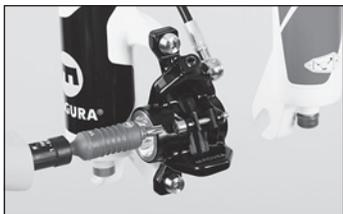
◀ Avvitare la vite di fissaggio delle pastiglie con la chiave di serraggio dinamometrica MAGURA. Coppia di serraggio: 2,5 Nm.
