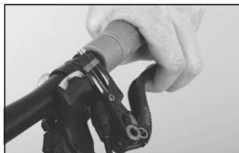
Nei freni a disco il punto di pressione deve essere subito stabile. Se dopo due terzi della corsa non è ancora stato raggiunto il punto di pressione, spingete un paio di volte la leva ("pompare") fino a che le pastiglie non aderiscono al disco. Se il punto di pressione dovesse spostarsi in fase di marcia è necessario spurgare l'impianto frenante.
