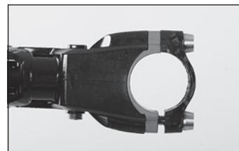
◀ Svitare e togliere i dadi di serraggio del corpo leva, estraete la fascetta di serraggio del corpo leva.
