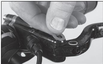
◀ Applicate a mano i dischi di copertura sul perno della leva freno.
