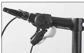
◀ Ruotate il corpo leva in posizione orizzontale.
