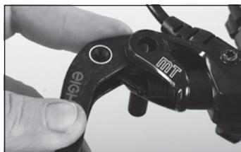
◀ Orientate la leva freno in modo che il foro sia perfettamente in linea con il perno della leva.
