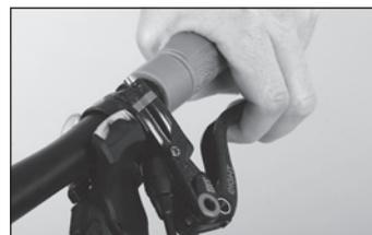
◀ Verificate i freni da fermi tirando la leva del freno verso il manubrio con due dita ed esercitando una normale pressione. La leva freno non deve toccare la manopola! Nei freni a disco il punto di pressione deve essere subito stabile. Se dopo due terzi della corsa non è ancora stato raggiunto il punto di pressione, spingete un paio di volte la leva ("pompare") fino a che le pastiglie non aderiscono al disco.
