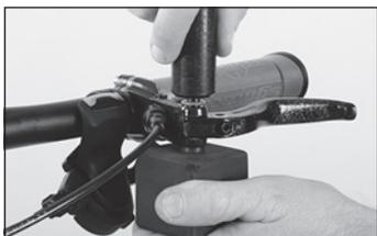
◀ Inserite l'espulsore da sopra nel perno della leva e spingete fino all'arresto. Far sì che l'espulsore e il Lever Cube siano correttamente allineati.
