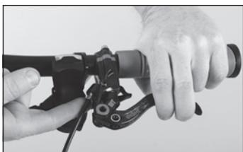
◀ Tirate la leva mantenendo la pressione e verificate che tutti i collegamenti, i tubi, le viti di spurgo e il serbatoio siano ermeticamente chiusi. In alternativa: utilizzate il “Pro Bleed Kit”.
