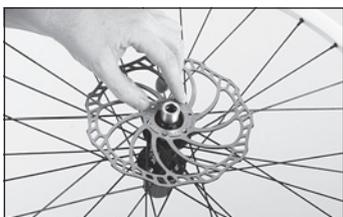
◀ Verificate che il senso di rotazione del disco sia corretto prima di applicare l'anello di blocco fornito col mozzo e prima di stringere la coppia di serraggio.
