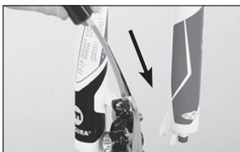
◀ Inserire ancora un po' di olio minerale nel circuito con la siringa in basso fino a che il foro di spurgo EBT sul corpo leva non sarà pieno fino all'orlo.
