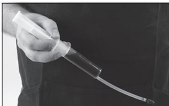
◀ Preparate la siringa di riempimento inserendo il raccordo con filetto M6 corto nel tubo di spurgo trasparente e l'altro estremo del tubo nella siringa. Immergete la siringa nel flacone MAGURA ROYAL BLOOD e aspirate fino a riempirla completamente. Tenete per alcuni secondi la siringa in posizione verticale con il raccordo filettato rivolto verso l'alto per permettere all'aria di salire. Premete leggermente lo stantuffo per consentire la fuoriuscita di tutta l'aria.
