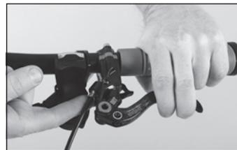
6. Tirate la leva mantenendo la pressione e verificate che tutti i collegamenti, i tubi, le viti di spurgo e il serbatoio siano ermeticamente chiusi.
