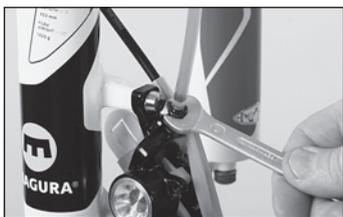
◀ Svitare il raccordo di riempimento dalla bocchetta sulla pinza freno.
