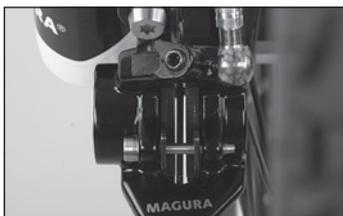
◀ Rilasciate al leva freno e verificate la posizione della pinza sul disco. Se il disco non è posizionato al centro della fessura della pinza effettuate nuovamente il montaggio.
