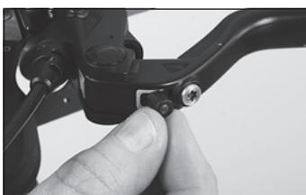
◀ I corpi leva BAT della serie MT di MAGURA consentono di impostare anche il punto di pressione, ovvero il punto in cui le pastiglie dei freni aderiscono al disco del freno. Ruotate la vite BAT posta sul corpo leva facendo attenzione che la leva freno non vada a toccare la manopola.
