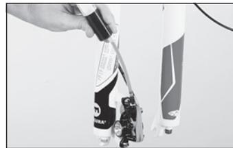
◀ Avvitare manualmente il raccordo filettato nella boccetta di riempimento della pinza.
