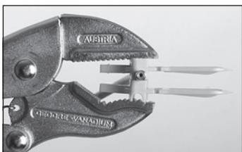
◀ Fissate il tubo nella scanalatura del blocco per il trasporto e fissatelo con un ulteriore blocco per il trasporto o con una pinza di presa (o con una morsa).
