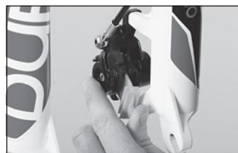
◀ Quando le ruote sono smontate, inserite sempre il blocco per il trasporto incluso nella confezione nella pinza del freno.
