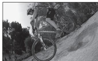
Quando frenate a fondo il peso viene trasferito sulla parte anteriore, mentre la ruota posteriore viene alleggerita. Su fondo non scivoloso quindi è più probabile che la ruota posteriore si sollevi e che la bicicletta si capotti piuttosto che i pneumatici perdano aderenza al terreno. Questo problema interessa maggiormente i percorsi di montagna. Quando frenate a fondo dovete quindi tentare di trasferire il vostro peso il più possibile all'indietro e verso il basso.
