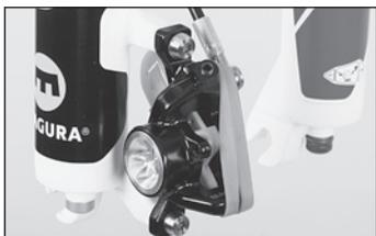
◀ Posizionate la bicicletta sul cavalletto di servizio in modo che i fori PM della pinza siano esattamente verticali e allineati uno sopra l'altro. In questo modo la terminazione del tubo si trova nel punto più alto della pinza. **Solamente in questa posizione è possibile effettuare il riempimento della pinza senza che entri aria o lo spurgo completo!**
