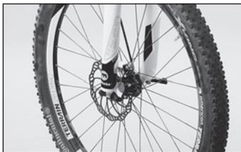
1. Verificate che le ruote siano ancora ben fissate ai portaruota (forcellini) e che i cerchi siano ancora centrati nel telaio e nella forcella. Fate girare le ruote ed osservate la fessura tra telaio e pneumatici.
