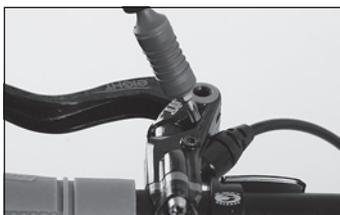
◀ Avvitare la vite di chiusura EBT nel foro di spurgo EBT e stringete con la chiave di serraggio dinamometrica MAGURA. Coppia di serraggio: 0,5 Nm. La vite EBT deve essere sullo stesso livello dell'alloggiamento.
