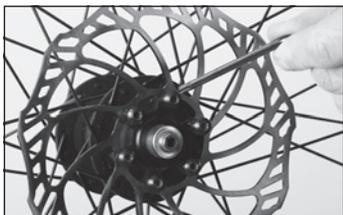
◀ Utilizzate solamente viti originali nuove o nel caso in cui utilizzate viti già montate, versate prima una goccia di frenafilletti (a media resistenza, ad es. Loctite 243) sul filetto.
