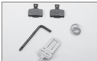
13. Controllate di aver messo nel bagaglio da viaggio il kit di riparazione dell'impianto frenante: chiave Torx T25, 1 coppia di pastiglie, blocco per il trasporto, elastico.
