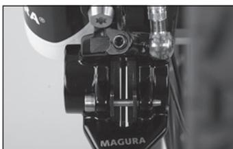
Quando i pistoncini del freno scorrono in modo irregolare nella pinza, il punto di pressione si avvicina al manubrio provocando rumori da sfregamento. “Mobilizzando” i pistoncini passivi si può risolvere il problema. Le pastiglie si centeranno di nuovo sul disco impedendo che si generino rumori da sfregamento.
