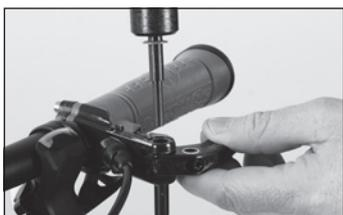
◀ Sfilate dal perno della leva l'espulsore unitamente al disco di copertura.
