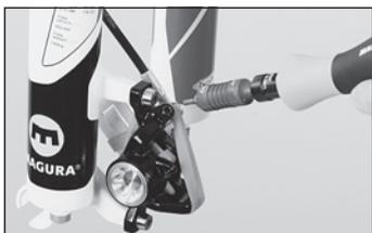
◀ Richiudete la bocchetta con la vite di riempimento. Coppia di serraggio: 2,5 Nm.
