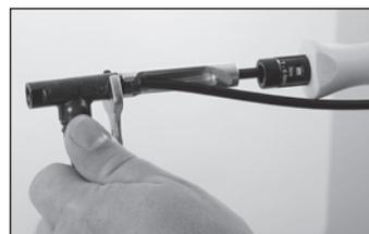
◀ Avvitare manualmente al pressostato il dado di ancoraggio facendo fare 2 o 3 rotazioni. Fissate il pressostato con la chiave a forchetta da 10 mm e avvitate il dado di ancoraggio con la chiave a forchetta da 8 mm. Tenete il tubo ben fermo nel pressostato fino a che il dado di ancoraggio non è serrato. Coppia di serraggio: 4 Nm.
