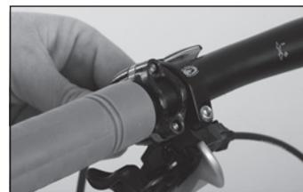
◀ Alla fine stringete a fondo il dado di serraggio inferiore. Coppia di serraggio massimo: 3 Nm.
