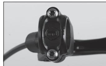
◀ Il corpo leva può essere montato indifferentemente a sinistra o a destra del manubrio, è sufficiente orientare correttamente la fascetta di serraggio del corpo leva. L'estremità più spessa deve essere rivolta verso l'alto. Sulle fascette di serraggio in alluminio è stampata anche una freccia. Il logo MAGURA deve essere ben visibile.
