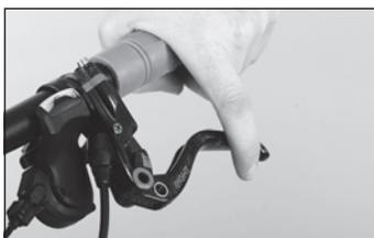
◀ Posizionate la leva in modo che sia facilmente raggiungibile aiutandovi con l'apposita vite di regolazione e con la chiave Torx T25, in modo che le prime falangi delle dita tocchino agevolmente la leva del freno, ovvero senza dover tirarla.
