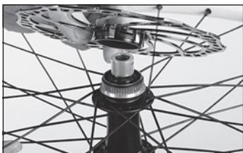
◀ Inserite il disco con il Center Lock Adapter MAGURA sul Center Lock dentellato del mozzo.
