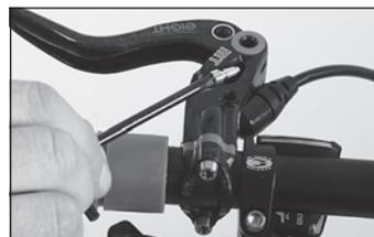
◀ Svitare la vite di chiusura EBT superiore del corpo leva con la chiave Torx T25.
