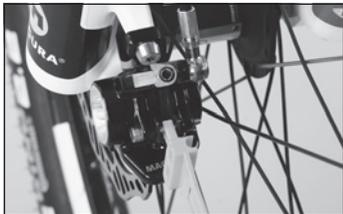
◀ Controllate se è possibile inserire la forchetta del blocco per il trasporto tra le "orecchiette" delle pastiglie. In caso negativo è necessario sostituire le pastiglie.
