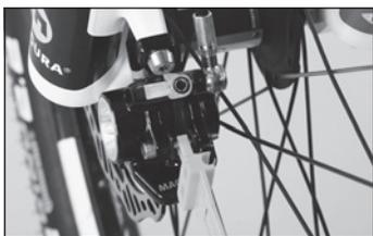
5. Tirate la leva e verificate lo stato di usura delle pastiglie. Provate ad inserire la parte posteriore del blocco per il trasporto tra le "orecchiette" delle pastiglie. Se non è possibile significa che le pastiglie sono usurate e devono quindi essere sostituite immediatamente.
