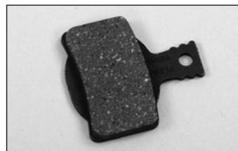
3. Le pastiglie nuove, perché raggiungano valori di decelerazione ottimali, devono essere sottoposte a un rodaggio, che consiste nell'effettuare 30-50 frenate a fondo a circa 30 km/h. Il rodaggio è concluso nel momento in cui la forza della mano necessaria per frenare non diminuisce ulteriormente.
