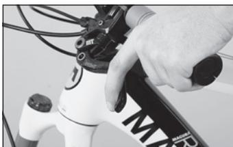
3. I corpi leva sono orientati correttamente o si sono spostati sul manubrio? In questo caso allentate il dado di serraggio inferiore, riportate il corpo leva nella posizione corretta e stringete nuovamente il dado come illustrato nel capitolo "Montaggio dei freni".
