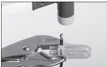
◀ Servendovi del martello di gomma inserite con cautela una nuova bussola di rinforzo nel tubo fino all'arresto.
