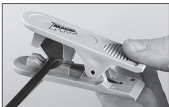
◀ Tagliate il tubo con la taglierina MAGURA nel punto ottimale per posizionare il pressostato. Tagliate il tubo perpendicolarmente tenendolo più vicino possibile al punto di taglio in modo da evitare perdite d'olio.
