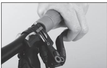
◀ Verificate i freni da fermi tirando la leva verso il manubrio con due dita ed esercitando una normale pressione. La leva freno non deve toccare la manopola! Nei freni a disco il punto di pressione deve essere subito stabile. Se dopo due terzi della corsa non è ancora stato raggiunto il punto di pressione, spingete un paio di volte la leva (“pompare”) fino a che le pastiglie non aderiscono al disco.
