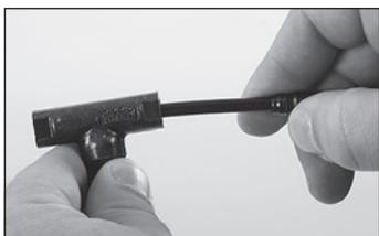
◀ Inserite il dado di ancoraggio e un nuovo anello di fissaggio su un'estremità del tubo. Inserite il tubo con dado e anello di fissaggio nel pressostato fino all'arresto.
