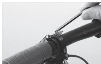
◀ Svitare il dado di serraggio inferiore del corpo leva di 1 o 2 giri.
