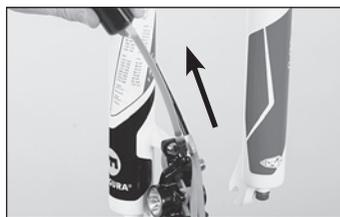
◀ Aspirate l'olio minerale con la siringa di riempimento in basso. Controllate che nella siringa sul corpo leva ci sia sempre abbastanza olio affinché non entri aria nel circuito.
