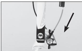
◀ Fate fluire lentamente l'olio minerale attraverso il freno utilizzando la siringa inserita nella pinza fino a che la seconda siringa nel corpo leva è piena.
