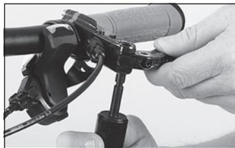
◀ Inserite l'espulsore da sotto nel perno della leva e spingete fino a metà del corpo leva.
