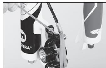
◀ Svitare la vite di riempimento della pinza freno con la chiave a brugola da 3 mm.
