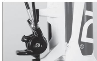
Per posare il tubo in modo ottimale, i freni a disco MAGURA della serie MT (escluso: modello MT 2) sono dotati di un innovativo allacciamento RHR ("Rotatable Hose Routing"). Questo consente di regolare l'angolazione del tubo rispetto alla pinza senza aprire il circuito frenante, senza quindi che questo debba essere riempito o spurgato.
