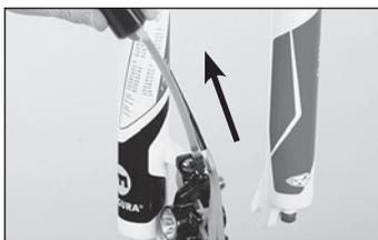
◀ Aspirate l'olio minerale con la siringa di riempimento in basso. Controllate che nel flacone del kit Pro Bleed sul corpo leva ci sia sempre abbastanza olio affinché non entri aria nel circuito.
