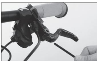
◀ Fate scorrere il corpo leva sul manubrio in modo che una o due dita (a piacere) si trovino sulla leva del freno. Regolate la posizione della leva del cambio in modo che sia facilmente manovrabile.
