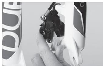
◀ Rimuovete la ruota per lavorare liberamente sulla pinza. Spingete delicatamente i pistoncini passivi nelle pinza con le pastiglie montate aiutandovi col blocco per il trasporto o con un cacciavite piatto. Non forzare. Spingete delicatamente i pistoncini in sede facendo pressione su diversi punti, fino a che non saranno rientrati in sede senza mai applicare una forza eccessiva.
