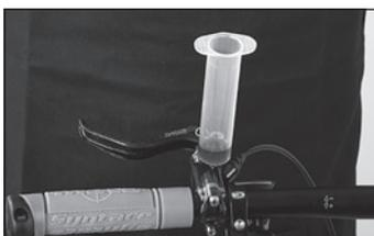
◀ Inserire l'estremità della seconda siringa di riempimento senza stantuffo fino in fondo nel foro di spurgo EBT superiore. In alternativa: utilizzate il "Pro Bleed Kit".
