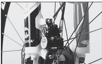
◀ Separate le pastiglie dei freni nella pinza freno aiutandovi con il blocco per il trasporto o con un cacciavite e posizionate la pinza sul supporto di montaggio PM del telaio o della forcella, o eventualmente sull'adattatore pinza. Fate attenzione a posizionare correttamente il disco tra le pastiglie dei freni. Stringete le viti di fissaggio della pinza freno quanto basta perché sia possibile spostare la pinza con la mano.
