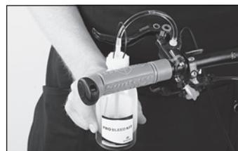
◀ Inserite il raccordo EBT del flacone del kit Pro Bleed fino in fondo nel foro di spurgo EBT.
