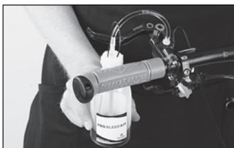
◀ Quando, eseguendo i passaggi sopra descritti, vedete che non escono più bolle d'aria, aspirate l'olio minerale con la siringa in basso fino a che nel flacone del kit Pro Bleed in alto resterà poco olio minerale.
