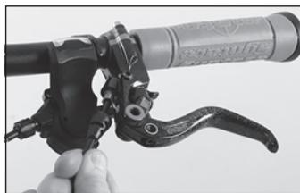
◀ Spingete il tubo nel corpo leva fintanto che il dado non è ben stretto. Coppia di serraggio: 4 Nm.
