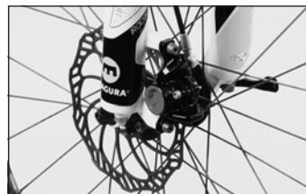
1. Conoscete già i freni a disco idraulici MAGURA? Verificate che il freno della ruota anteriore sia azionato dalla stessa leva freno (destra o sinistra) che usate di solito. Qualora non fosse così, prima della prima uscita fate modificare il corpo leva dal vostro rivenditore MAGURA.
