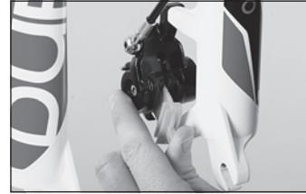
◀ Rimuovete la ruota per lavorare liberamente sulla pinza.
