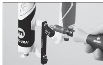
◀ Montate l'adattatore alla forcella o al telaio, qualora fosse necessario, utilizzando le viti di fissaggio in dotazione.
