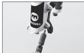
A riguardo leggete con attenzione la sezione "Adattatore per pinza freno" nel capitolo "Accessori + utensili" del presente manuale Coppia di serraggio: 6 Nm.
