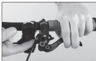
◀ Attivate la leva freno e verificate il punto di pressione. Se la leva non diventa dura è necessario spurgare i freni (vedi capitolo "Manutenzione"). Se la leva diventa dura tenete il freno tirato e verificate che gli allacciamenti del tubo non presentino perdite.
