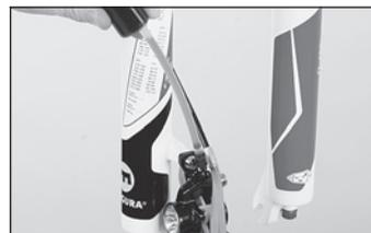
◀ Spurgate / riempite l'impianto frenante come indicato nel capitolo "Spurgo / riempimento dell'impianto frenante" del presente manuale MAGURA. Ruotate il pressostato in modo che il cavo di allacciamento sia rivolto verso il basso.
