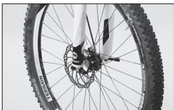
◀ Montate la ruota con il freno a disco già montato sul telaio o sulla forcella e serrate i bloccaggi rapidi o i perni passanti secondo le indicazioni del costruttore. Verificate infine che i cerchi si trovino al centro del telaio o della forcella e che le ruote possano girare liberamente.
