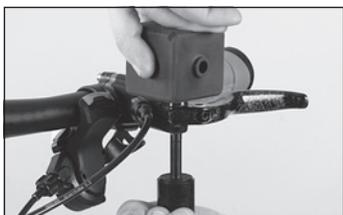
◀ Spingete il perno della leva freno verso l'alto fino all'arresto aiutandovi con l'espulsore e muovete la leva fino a che l'asta di spinta fa "clic".
