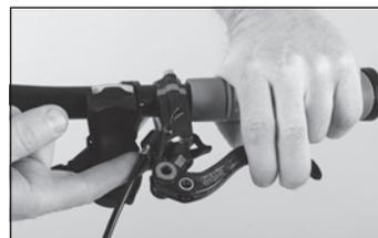
◀ Tirate la leva mantenendo la pressione e verificate che tutti i collegamenti, i tubi, le viti di spurgo e il serbatoio siano ermeticamente chiusi.
