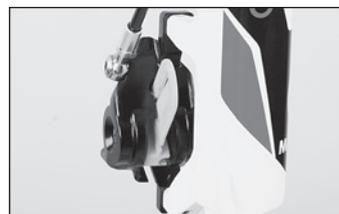
◀ Inserite il lato più spesso del blocco per il trasporto nella pinza tra i pistoncini passivi e bloccate con l'elastico.
