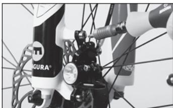
◀ Attivate ripetutamente la leva freno fino a quando le pastiglie non avranno aderito al disco. Tenete la leva freno tirata. Serrate gradualmente ed alternativamente viti di fissaggio della pinza freno. Coppia di serraggio: 6 Nm.
