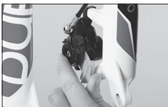
◀ Spingete lentamente i pistoncini passivi nella sede della pinza con le pastiglie montate aiutandovi con il blocco per il trasporto o con un cacciavite piatto. Non forzare. Spingete delicatamente i pistoncini in sede facendo pressione su diversi punti, fino a che non saranno rientrati in sede senza mai applicare una forza eccessiva.
