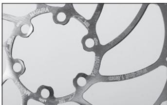
◀ Montate il disco sul fissaggio del mozzo a 6 fori. Posizionate il disco rispettando il senso di rotazione come indicato dalla freccia impressa sul disco stesso, con la scritta rivolta verso l'esterno. Stringete le viti di fissaggio del disco con la chiave Torx T25, quanto basta perché il disco possa ruotare con un leggero movimento della mano.
