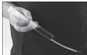
◀ Preparate la siringa di riempimento inserendo il raccordo con filetto M6 corto nel tubo di spurgo trasparente e l'altro estremo del tubo nella siringa. Immergete la siringa di riempimento nel flacone MAGURA ROYAL BLOOD e aspirate fino a riempirla completamente. Tenete per alcuni secondi la siringa in posizione verticale con il raccordo filettato rivolto verso l'alto per permettere all'aria di salire. Premete leggermente lo stantuffo per consentire la fuoriuscita di tutta l'aria.
