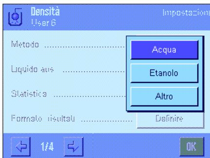
**"Acqua":** La densità dell'acqua distillata alle temperature da 10.0°C a 30.0°C è memorizzata nella bilancia.
