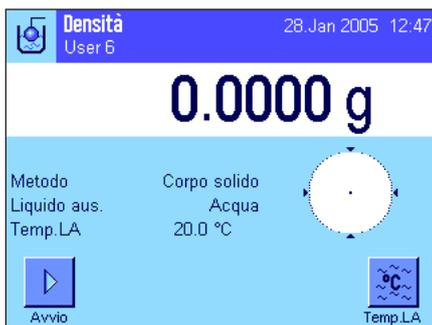
Dopo la scelta dell'applicazione appare quanto indicato a lato. I tasti funzione e i campi informazione relativi alla determinazione della densità sono attivati all'origine. La bilancia è preimpostata per la determinazione della densità di corpi solidi utilizzando acqua come liquido ausiliario. È possibile adattare queste impostazioni alle esigenze personali, seguendo le istruzioni presenti nei prossimi capitoli.
