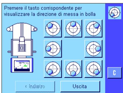
Osservare l'indicatore di livello della bilancia (illuminata quando il sensore di inclinazione è attivo) e premere il tasto che mostra l'attuale posizione della bolla d'aria nella livella.
