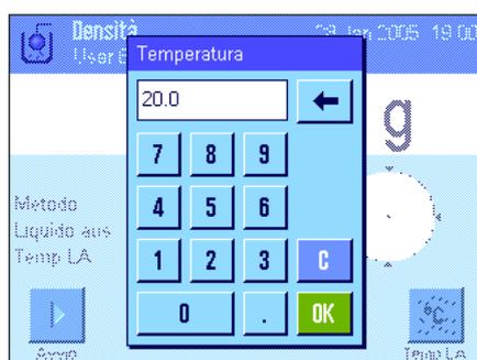
Se si utilizzano **acqua o etanolo come liquidi ausiliari**, inserirne la **temperatura** tramite il tasto funzione "**Temp. LA**" (per entrambi i liquidi sono memorizzate, nella bilancia, le tabelle della densità in considerazione di un campo di temperature da 10 °C a 30 °C, ved. anche i capitoli 12.7 e 12.8). La figura a fianco mostra il campo di inserimento corrispondente (inserimento in °C con 1 decimale).
