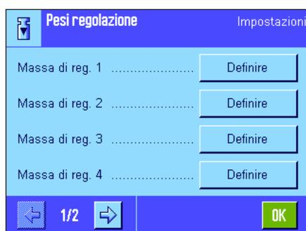
Se si lavora con masse di regolazione esterne, è possibile stabilirne le caratteristiche. In entrambe le pagine del menu è possibile definire fino a 5 masse di regolazione esterne. Durante il livellamento (capitolo 7.4.3) è possibile scegliere con quale delle masse predefinite si desidera effettuare la regolazione.
