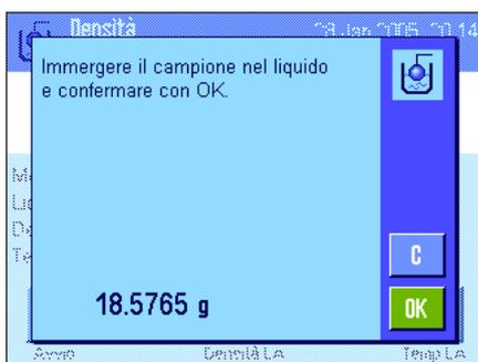
Il risultato della pesata viene memorizzato, poi viene richiesto di immergere il corpo nel liquido ausiliario.
