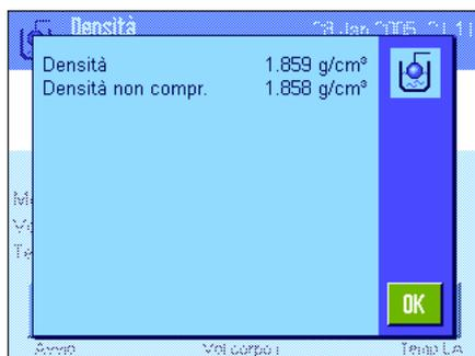
La bilancia determina la densità del liquido e visualizza il risultato (valore compensato o non compensato, a seconda delle impostazioni relative all'emissione del risultato, ved. capitolo 12.3.5).
