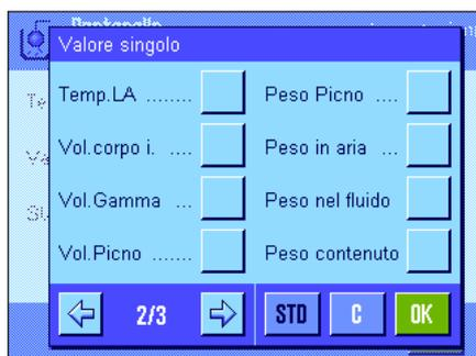
**"Vol. corpo i. ....":** Registra il volume del corpo a immersione inserito tramite l'apposito tasto funzione (determinazione della densità di liquidi con l'ausilio di un corpo a immersione).
