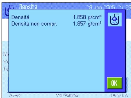
La bilancia determina la densità della sostanza pastosa e visualizza il risultato (valore compensato o non compensato, a seconda delle impostazioni relative all'emissione del risultato, ved. capitolo 12.3.5).
