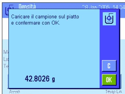
Premere il tasto funzione "**Avvio**", per avviare la determinazione della densità. La bilancia eseguirà automaticamente la messa in tara, poi richiederà di posizionare sul piatto il corpo da pesare (prima pesata in aria).
