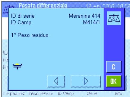
La bilancia visualizza il primo campione della serie per cui non sia già stato rilevato un valore di pesata finale. Se si desidera eseguire la pesata finale di un altro campione, premere la freccia sul lato inferiore della finestra. In questo esempio si suppone che si desideri iniziare dal primo campione. Confermare con "OK".
