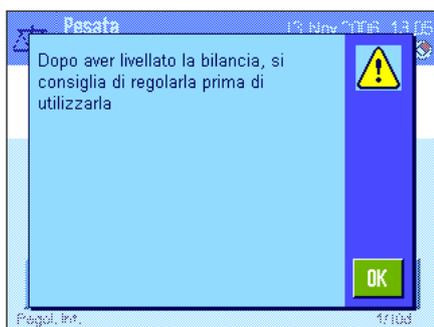
Prima che la bilancia torni alla modalità di pesata, comparirà un messaggio che raccomanda di regolare la bilancia dopo il livellamento. Confermare il messaggio con **"OK"**.
