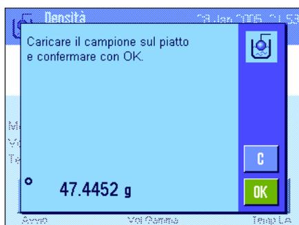
Premere il tasto funzione "Avvio" per dare inizio alla determinazione della densità. Verrà richiesto il posizionamento del campione (senza sfera gamma).
