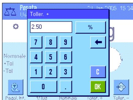
Una volta inseriti il valore nominale e le tolleranze, sul display appare la guida grafica per i dosaggi ("SmartTrac") con i limiti di tolleranza, utile per il dosaggio sulla base del valore nominale: È possibile dosare i campioni approssimativamente fino al raggiungimento della tolleranza minima, per poi, all'occorrenza, dosare accuratamente fino al valore nominale.
