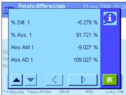
Nel caso in cui i risultati di un campione comprendano diverse finestre, è possibile passare da una finestra di risultato all'altra tramite il tasto di scorrimento in basso a sinistra.
