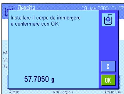
Premere il tasto funzione "Avvio", per dare inizio alla determinazione della densità. Verrà richiesta l'installazione del corpo a immersione (pesata in aria).
