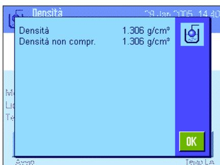
La bilancia determina la densità del corpo solido e visualizza il risultato (valore compensato o non compensato, a seconda delle impostazioni relative all'emissione del risultato, ved. capitolo 12.3.5).
