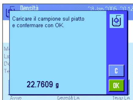
Premere il tasto funzione "**Avvio**" per iniziare la determinazione della densità. La bilancia effettuerà una tara automatica; poi verrà richiesto di posizionare il corpo solido (pesato in aria).
