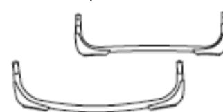
Posizionare un tubo della suddetta base sul pavimento come mostrato in figura. Inserire ciascuna estremità del tubo nel rispettivo alloggiamento del telaio con perno posto di fronte.
