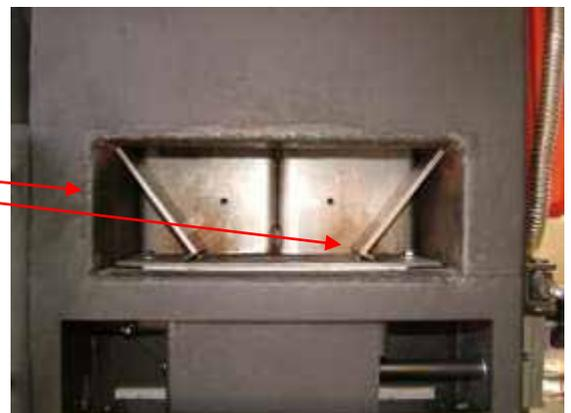
Particolare attenzione alla guarnizione del cassetto ceneri; nel caso si notasse un deterioramento sostituirla subito.
