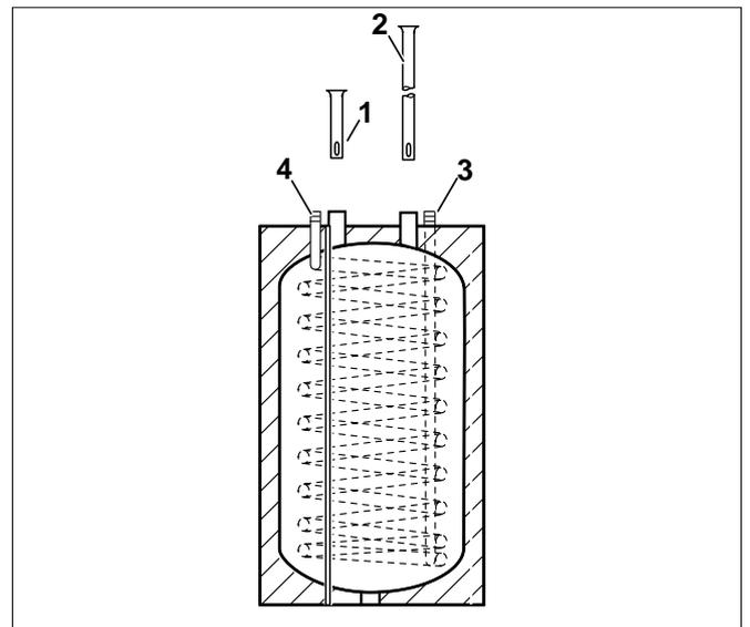
Fig. 7 Attacco dall'alto (montaggio degli apparecchi uno sopra l'altro)
