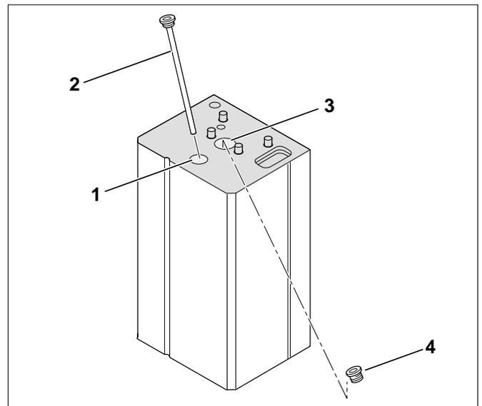
Fig. 11 Posizione tappo/apertura di ispezione
