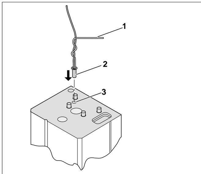
Fig. 10 Montaggio della sonda (schizzo di principio)
