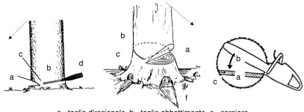
a - taglio direzionale, b - taglio abbattimento, c - cerniera, d - cuneo/leva di abbattimento.
