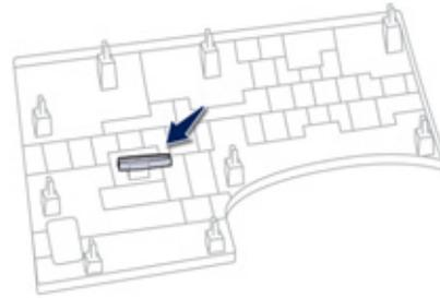
La pinzetta d'estrazione è fissata sul retro del coperchio della scatola portafusibili del cruscotto.
