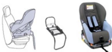
Si posiziona con le spalle verso la strada mediante una base ISOFIX che si aggancia agli anelli **A**, dotata di un'asta (tipo A) che va ad appoggiarsi al pianale del veicolo.
