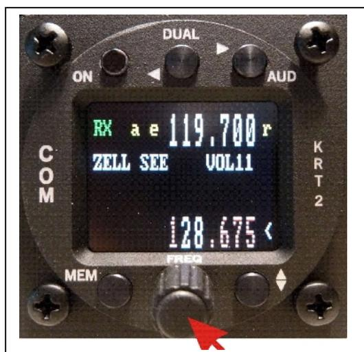
Impostare la frequenza passiva (in basso nel display) con la manopola, partendo da MHz, poi 100- kHz e 10- kHz.
