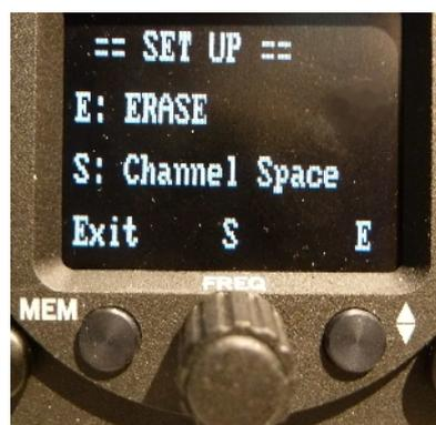
Il SET UP - menu può essere terminato con MEMORY. Il dispositivo rimane acceso e torna alla modalità di funzionamento normale..
