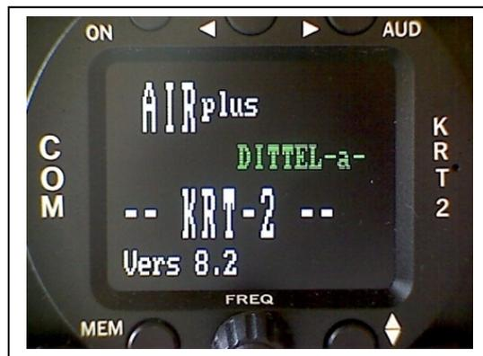
La schermata iniziale mostra il tipo di dispositivo, la versione del software. Il dispositivo poi ritorna al funzionamento normale (modus di invio diretto).
