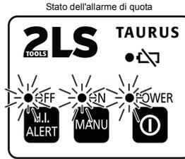
Le tre spie lampeggiano contemporaneamente e la testina rotante ruota a bassa velocità.
