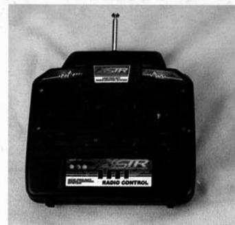
采用威迪标准化3通比例遥控设备，性能稳定，可操纵实用性强，体现飞机优异的操纵性能。
