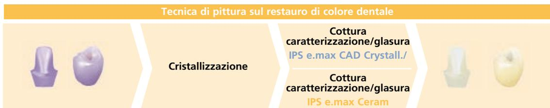
Cristallizzazione senza applicazione di masse; cottura di caratterizz./glasura separata a scelta con masse IPS e.max CAD Crystall./ oppure IPS e.max Ceram.
