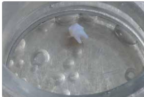
Detergere la struttura ceramica in bagno ad ultrasuoni ...
