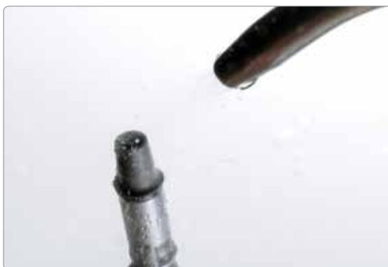
Eliminare il silicone e quindi detergere in bagno ad ultrasuoni o con vaporizzatore.
