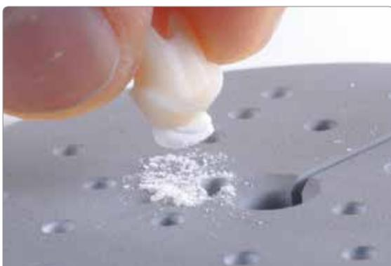
Prelevare la struttura ceramica dal portaoggetti IPS e.max CAD Crystallization Tray.
