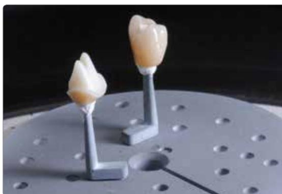
Al termine del processo di cottura (attendere il segnale acustico del forno), prelevare le strutture ceramiche dal forno di cottura.
