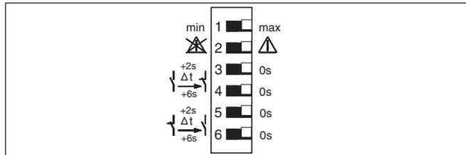
Figura 3: Commutatori DIL VEGATOR 121
