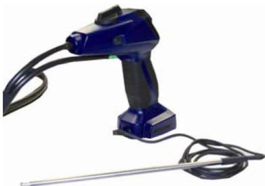
**Sonda temperatura aria** con sensore da 280 mm e cavo 2 m per la misura della temperatura dell'aria comburente nel canale d'aspirazione (per es. per la caldaia tipo C o per caldaie a condensazione con l'aria comburente canalizzata)
