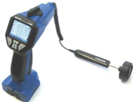
**Sonda temperatura tipo W** a termocoppia in esecuzione incapsulato per la misura con precisione delle temperature di superfici senza interferenza dell'eventuale vento o ricircolo d'aria come necessario per il calcolo del valore di trasmittanza U dei muri o le dispersioni del mantello di caldaia.
