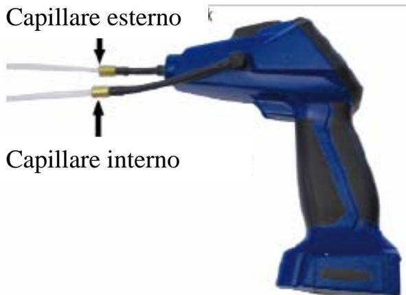
Collegare i capillari, uno alla sonda fumi e l'altra nel raccordo pressione (meno) al lato dell'analizzatore.
