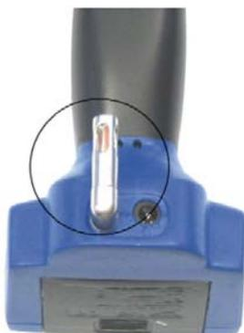
**Spinotto temperatura aria** per la misura della temperatura dell'aria comburente nel locale d'installazione (per es. per la caldaia atmosferica o per la centrale termica)
