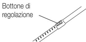
**Attenzione:** regolare la lunghezza del tubo telescopico in maniera tale da poter passare l'aspirapolvere in comoda posizione eretta (=schiena dritta)
