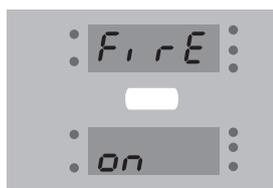
Dopo questa fase della durata di 5 minuti circa sul display superiore verrà visualizzata contemporaneamente la potenza calorica (es. **po 6**) e la temperatura ambiente (es. **25°**), mentre sul display inferiore verrà visualizzata la temperatura dell'acqua di mandata dell' impianto.
