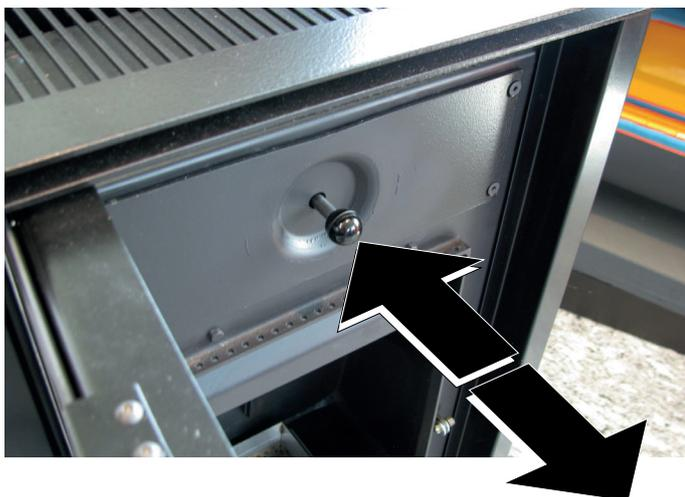
Ogni tre-quattro sacchi di pellet bruciati aprire la portainferiore e svitare i due pomelli che tengono il cassetto ispezione (Fig. 8);
