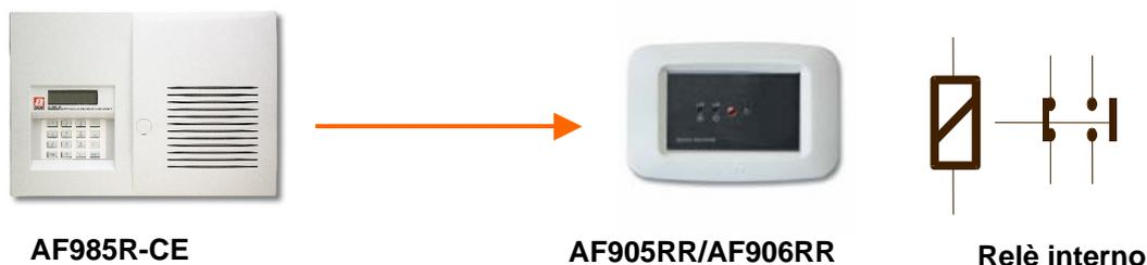
Il combinatore dialoga con il ricevitore inviando a questo un comando monostabile o bistabile. La funzione COMANDI RADIO permette di determinare, per ognuno dei 16 canali radio, il tipo di comando, monostabile (tipo rivelatore) o bistabile (tipo telecomando), che sarà inviato dal combinatore al ricevitore.
