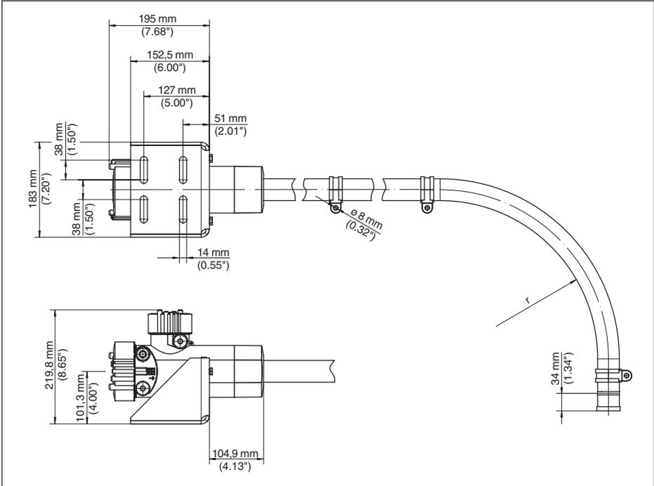
Figura 25: FIBERTRAC 31 con accessori di montaggio in dotazione
