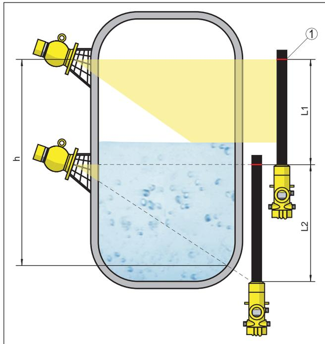
Figura 4: Posizione di montaggio - collegamento in cascata
