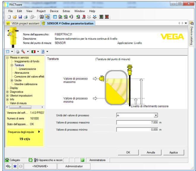
Figura 19: Esempio di una maschera DTM
