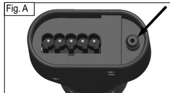
**Effettuare lo stesso controllo anche sulle guarnizioni di connessione dei tubi prolunga (7) e della pistola vaporizzatrice (2). Se necessario, sostituirla con l'apposito ricambio (15), come di seguito indicato.**
