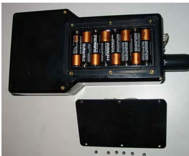
Fig. 2 – Alloggiamento delle batterie
